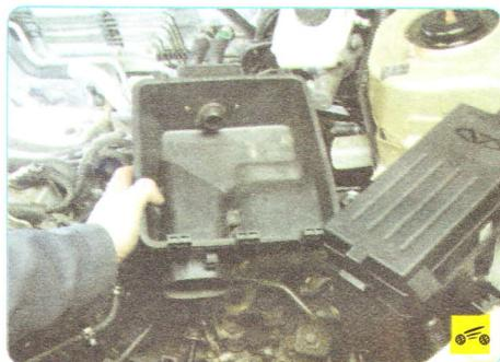
2. Снимите воздушный фильтр и воздухозаборник (см. «Снятие и установка воздушного фильтра и глушителя шума на впуске», с. 111).
