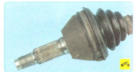
– наружный шарнир равных угловых скоростей должен поворачиваться с легким усилием без рывков и заеданий, радиальных и осевых люфтов. При их наличии замените шарнир;
