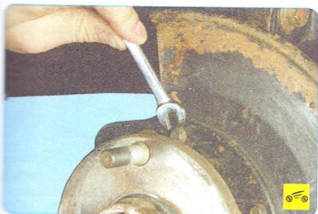
4. Выверните три винта крепления щита тормозного диска...
