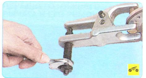
4. Установите съемник (для удобства фотографирования ступица снята) и выпрессуйте из отверстия ступицы шпильку.
