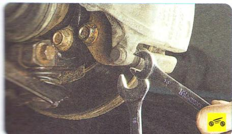
2. Ослабьте затяжку болта крепления нижнего направляющего пальца суппорта, удерживая палец от проворачивания вторым ключом...
