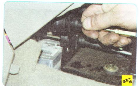
6. Извлеките из кронштейна кулисы рычага управления коробкой передач наконечник оболочки троса выбора передач.
