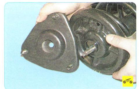
4. Снимите верхнюю опору стойки...
