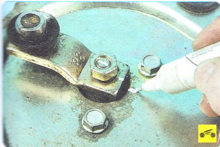
16. Пометьте расположение кривошипа относительно пластины трапеции стеклоочистителя...
