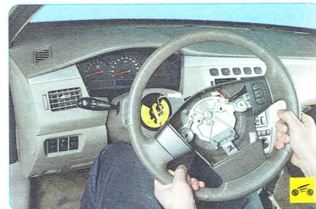
1. Снимите рулевое колесо (см. «Снятие и установка рулевого колеса», с. 163).
