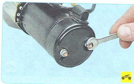
5. Выверните две гайки шпилек крепления задней крышки...
