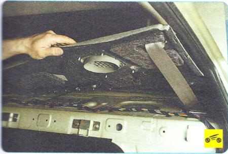
2. Приподнимите облицовку задней полки (см. «Снятие и установка облицовок салона», с. 274).
