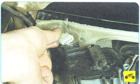
4. ...и отсоедините колодку от выводов моторедуктора.
