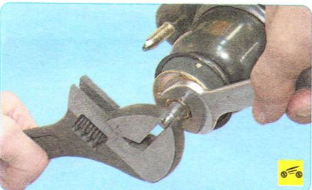
3. Отверните гайку штока, удерживая шток от проворачивания вторым ключом.
