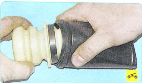
11. Снимите с буфера хода сжатия защитный кожух...
