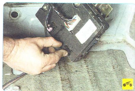
5. Нажмите на фиксатор черной колодки жгута проводов блока...
