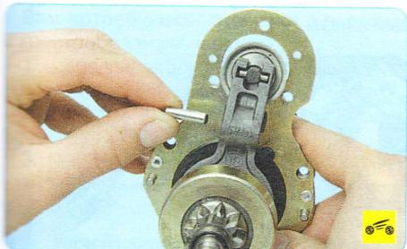
13. Извлеките штифт крепления рычага привода...
