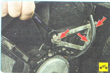
4. Выверните три болта крепления кронштейна дополнительного сопротивления...
