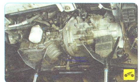
36. Установите под двигатель и коробку передач надежные опоры.
