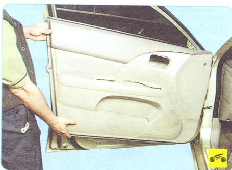
6. Для снятия и установки динамика, расположенного в передней двери, снимите обивку двери с соответствующей стороны (см. «Снятие и установка обивки передней двери», с. 250).
