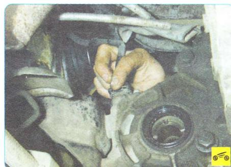
32. Нажмите на пружинный фиксатор колодки жгута проводов датчика скорости...
