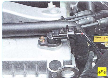
**Датчик положения распределительного вала (датчик фазы)** определяет ВМТ такта сжатия поршня 1-го цилиндра. Сигнал датчика используется контроллером для организации фазированного впрыска топлива в соответствии с порядком работы цилиндров. При возникновении неисправности цепи контроллер заносит в свою память ее код и включает сигнальную лампу.
