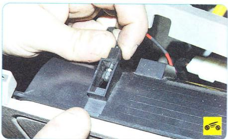
5. ...поверните патрон лампы подсветки пепельницы против часовой стрелки...
