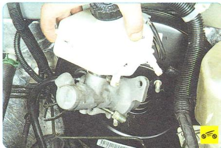
7. ...и снимите главный тормозной цилиндр в сборе с бачком.
