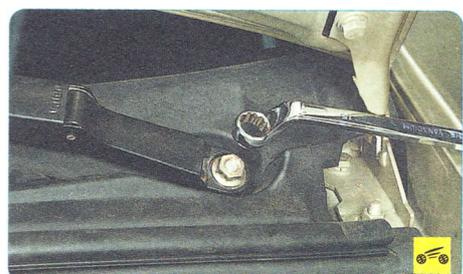
3. ...отверните гайку крепления рычага стеклоочистителя...
