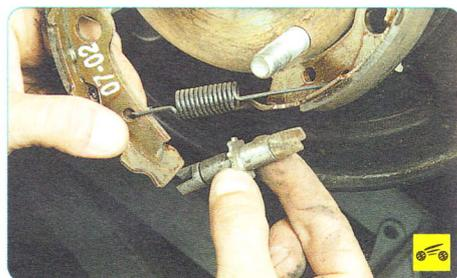
10. ...снимите регулировочное устройство...
