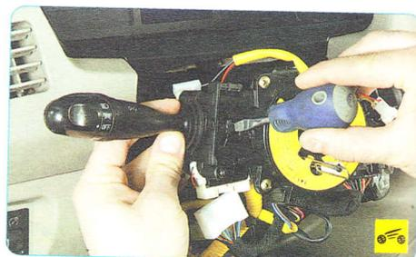
6. Нажмите на фиксатор корпуса подрулевого переключателя...
