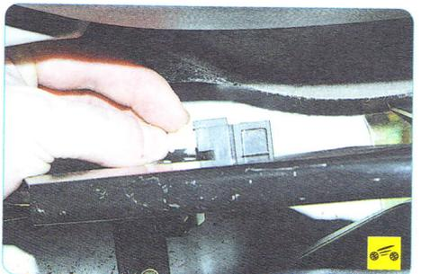
3. Нажмите на фиксатор колодки жгута проводов выключателя сигнальной лампы включения стояночного тормоза...
