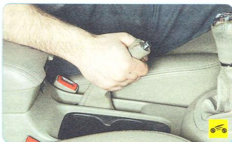
Рычаг привода стояночного тормоза, закрепленный между передними сиденьями на тоннеле пола, соединен с уравнителем передним тросом, резьбовой наконечник которого служит для регулировки натяжения тросов. Передние наконечники задних тросов соединены с уравнителем.
