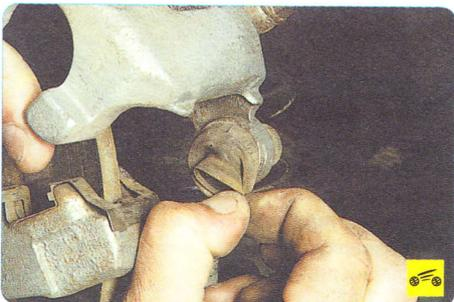
Замените защитный чехол направляющего пальца, если он затвердел, деформирован или надорван.
