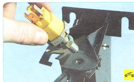
8. При необходимости замены снимите с кронштейна педали выключатель стоп-сигналов (см. «Замена датчиков и выключателей», с. 239).
