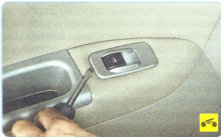
12. Для замены выключателя управления стеклоподъемником задней двери отверткой подденьте выключатель...
