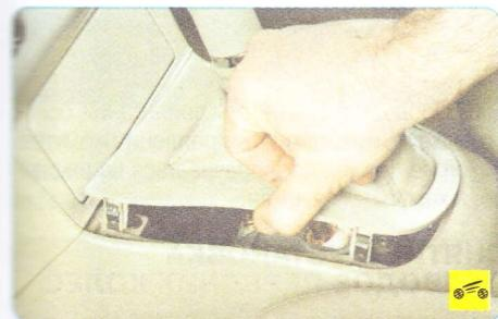
2. ...выведите фиксаторы из зацепления с краем гнезда в облицовке тоннеля пола...
