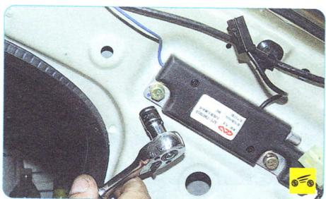
7. Выверните два болта крепления блока антенны...
