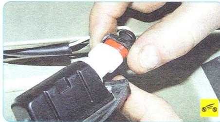
2. ...проверните патрон лампы против часовой стрелки...
