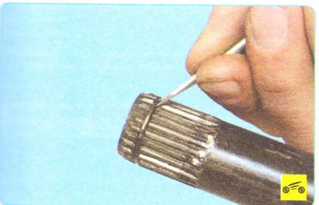
7. Снимите стопорное кольцо, выведя его отверткой из проточки вала.
