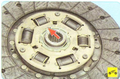
Устанавливайте ведомый диск таким образом, чтобы маркировка на его ступице была направлена в сторону коробки передач.
