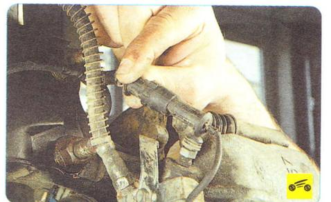
2. Извлеките из держателя колодку жгута проводов датчика износа накладки внутренней тормозной колодки...
