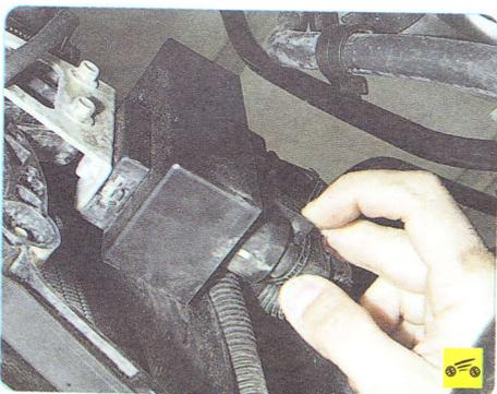
2. Нажмите на фиксатор колодки жгута проводов дополнительного сопротивления электровентилятора радиатора...
