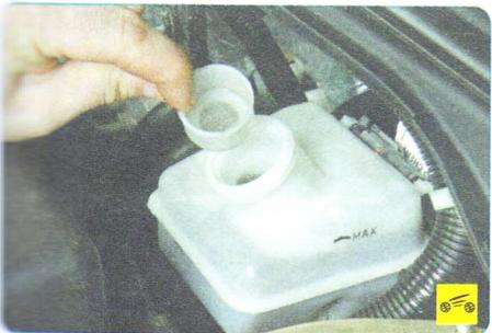
2. Извлеките из его горловины сетчатый фильтр и откачайте тормозную жидкость из секции бачка главного тормозного цилиндра, питающей гидропривод выключения сцепления, например, большим медицинским шприцем со шлангом.
