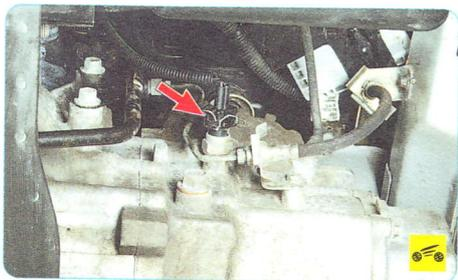
Выключатель света заднего хода установлен в передней части картера коробки передач.
