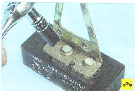
6. Выверните два болта крепления кронштейна дополнительного сопротивления...
