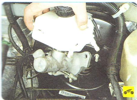
2. Снимите главный тормозной цилиндр (см. «Замена главного тормозного цилиндра», с. 179).
