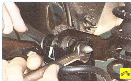
2. Отверните гайку болта крепления переднего нижнего рычага к кронштейну продольного рычага и извлеките болт.
