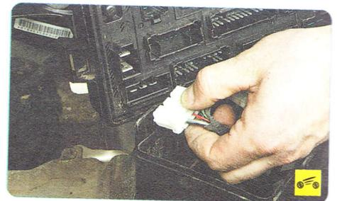
19. ...отсоедините колодку от соответствующих выводов монтажного блока...
