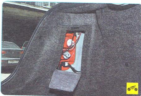
1. Откройте лючок в обивке или снимите облицовку багажника с соответствующей стороны (см. «Снятие и установка облицовок багажника», с. 276).
