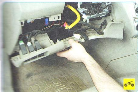
1. В салоне автомобиля снимите нижний декоративный щиток панели приборов (см. «Снятие нижнего декоративного щитка панели приборов», с. 272).
