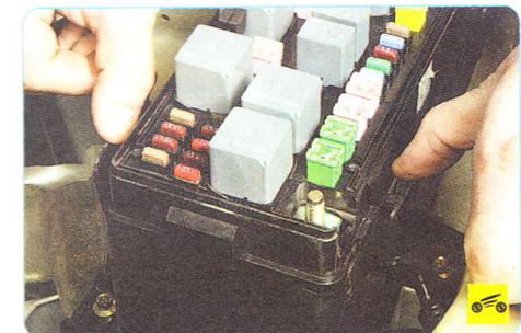
5. Отогните фиксаторы блока предохранителей...
