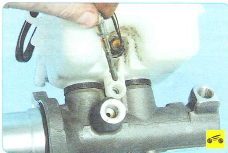
9. ...извлеките винт из отверстий бачка и цилиндра...
