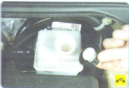
1. Снимите пробку бачка главного тормозного цилиндра...
