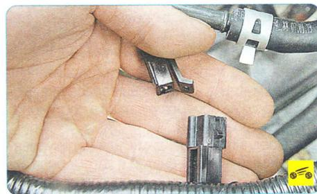
5. Разъедините колодку провода управляющего реле.
