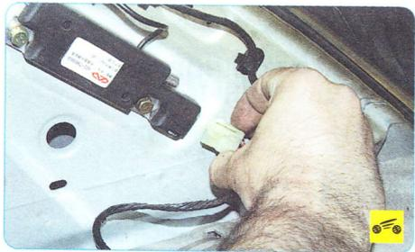
6. Нажмите на фиксатор колодки жгута проводов блока антенны и отсоедините колодку от выводов блока.
