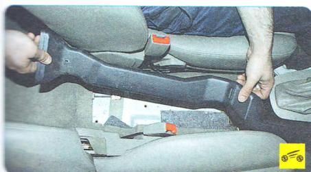
10. Снимите задний воздуховод...
