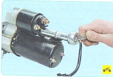
1. Отверните гайку на нижнем контактном болту тягового реле...
