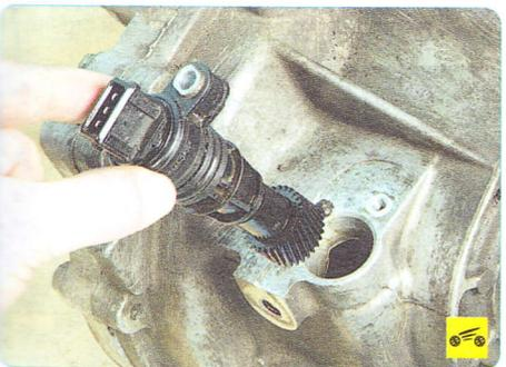
5. ...и снимите датчик скорости с автомобиля.
