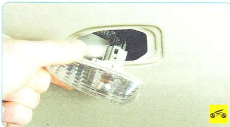
3. ...и извлеките его из отверстия в крыле.
