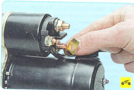
2. ...и отсоедините шину от контактного болта тягового реле.
