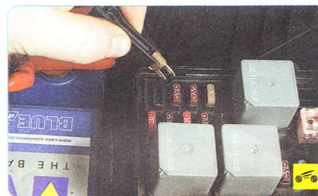
4. ...и извлеките заменяемый предохранитель.
