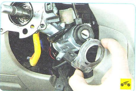
3. Подденьте световод подсветки замка зажигания и аккуратно снимите его с замка.
