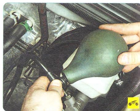
5. Плотно вставьте штуцер вакуумного шланга, которым он был присоединен к вакуумному усилителю, в отверстие груши (например, от ареометра) и сожмите ее. Воздух из груши должен выйти через клапан.
