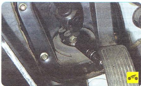
15. Выверните болт клеммового соединения промежуточного вала с валом-шестерней рулевого механизма.
