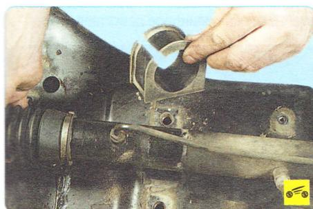
15. Снимите разрезную резиновую опору рулевого механизма.
