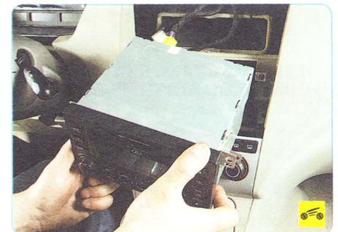
4. ...и извлеките автомагнитолу из панели приборов.
