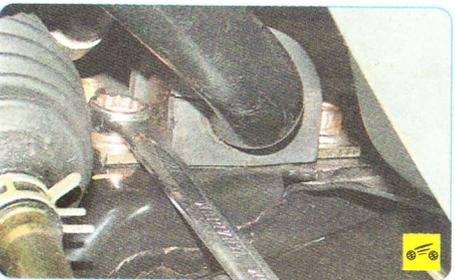
1. Выверните два болта крепления скобы подушек стабилизатора...
