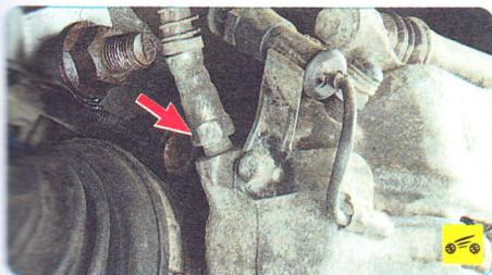
6. Осмотрите соединения шлангов с рабочими цилиндрами тормозных механизмов.
