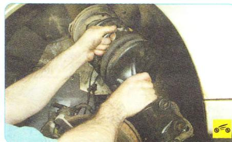
13. ...и снимите амортизаторную стойку с автомобиля.
