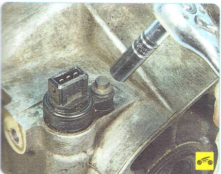
4. Выверните болт крепления датчика...
