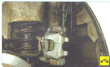
5. ... и подвяжите суппорт проволокой к пружине задней подвески, не допуская скручивания или натяжения шланга.
