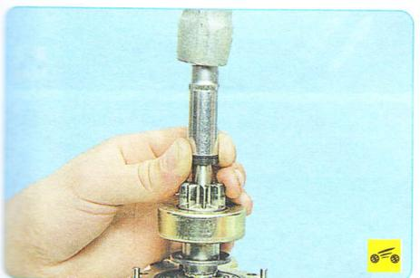
16. Для замены муфты привода сдвиньте по валу привода ограничительное кольцо, как показано на фото.
