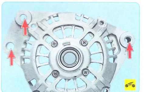
20. Осмотрите крышку генератора со стороны привода. Если при вращении подшипника чувствуется люфт между кольцами, перекат или заклинивание тел качения, повреждены защитные кольца или есть следы подтекания смазки, замените подшипник. Если обнаружены трещины в крышке, особенно в местах крепления генератора, необходимо заменить крышку новой.
