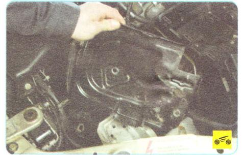
4. ...и полку ее крепления (см. «Снятие и установка полки крепления аккумуляторной батареи», с. 278).
