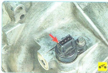
**Датчик скорости автомобиля** установлен на коробке передач. При вращении ведущих колес датчик скорости вырабатывает серию импульсов на 1 м движения автомобиля, а контроллер определяет скорость автомобиля по частоте подачи импульсов.
