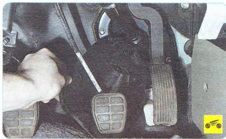
14. Снимите защитный кожух карданного шарнира вала рулевого управления.
