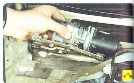
10. ...немного разверните трапецию стеклоочистителя вместе с моторедуктором...
