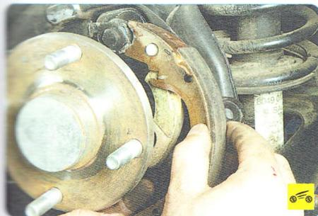
17. Извлеките заднюю тормозную колодку в сборе с разжимным рычагом из-за фланца задней ступицы...
