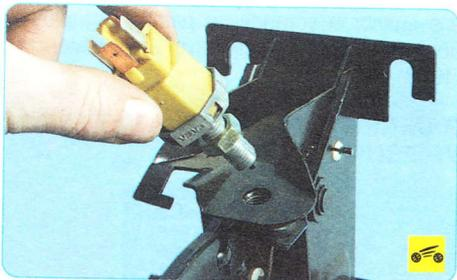
3. Выверните выключатель стоп-сигнала из отверстия кронштейна педали тормоза
