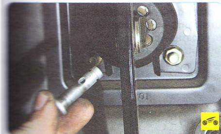
4. ...и выньте палец из отверстий вилки выключателя тормоза.
