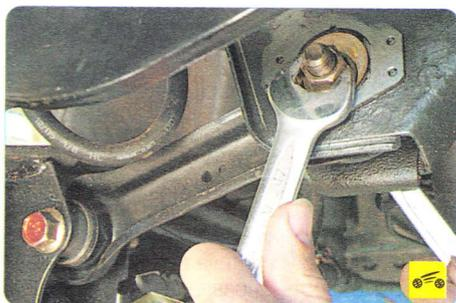
**Схождение задних колес** представляет собой угол между плоскостью вращения заднего колеса и продольной осью автомобиля. Схождение задних колес регулируют вращением регулировочного болта, находящегося с внутренней стороны рычага управления.
