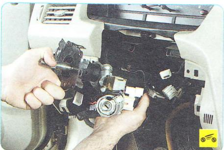
17. ...и снимите рулевую колонку с выключателем зажигания и промежуточным валом.
