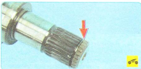
**Заменяйте стопорное кольцо хвостовика внутреннего шарнира новым при каждом снятии привода с автомобиля.**
