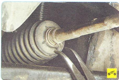
2. Сожмите отогнутые уши хомута крепления защитного чехла на рулевой тяге...
