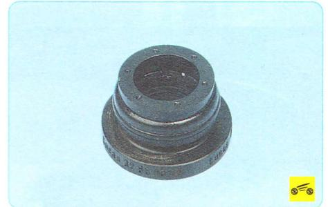
Повторное использование соединительных втулок не допускается, замените их новыми.
