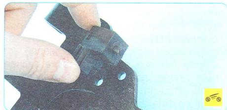
7. ...и снимите выключатель с корпуса рычага.
