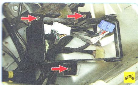
21. Выверните три винта крепления корпуса монтажного блока...
