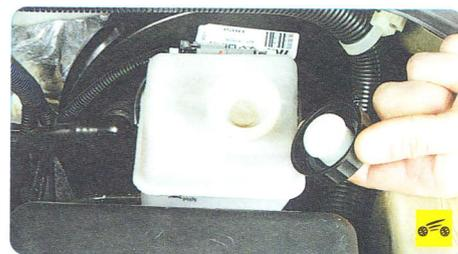
2. Отверните пробку бачка главного тормозного цилиндра...
