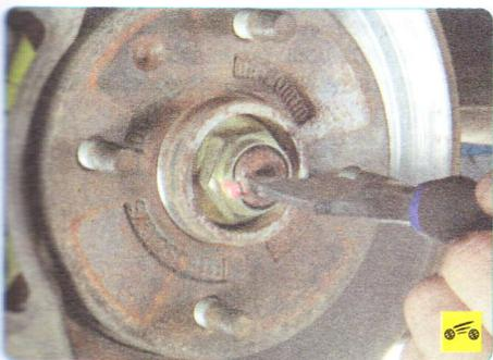
4. Разогните замятый край буртика гайки ступицы...
