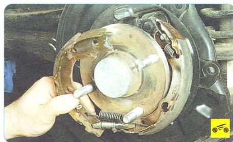
9. Преодолевая упругое сопротивление нижней стяжной пружины, выведите переднюю тормозную колодку из-за фланца задней ступицы...
