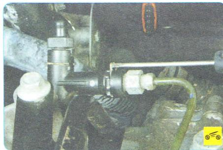
Верхний конец нижней трубки можно отсоединить от переходника, поддев отверткой пружинный фиксатор наконечника переходника...
