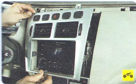
5. ...и, преодолевая сопротивление двух держателей наклейки, снимите ее с панели приборов.
