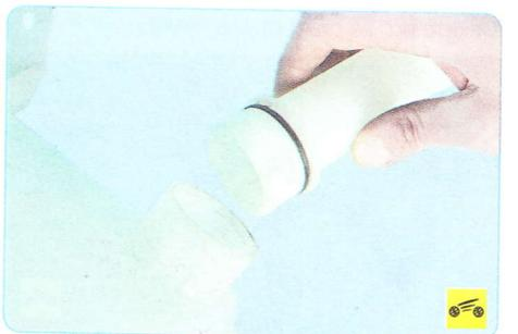
12. При необходимости снимите с бачка его наливную горловину...
