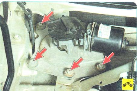
9. ...четыре болта крепления пластины трапеции стеклоочистителя...
