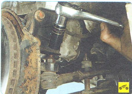
2. Отверните гайку крепления шарового пальца наконечника рулевой тяги к рычагу поворотного кулака.
