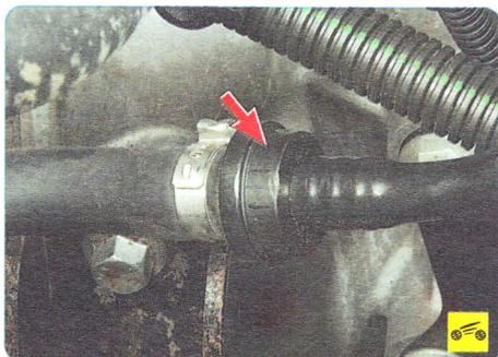
В шланге, соединяющем вакуумный усилитель с впускной трубой, установлен обратный клапан. Он удерживает разрежение в усилителе при его падении во впускной трубе и препятствует попаданию топливовоздушной смеси в вакуумный усилитель.
