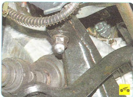
7. ...отверните по одной гайке переднего крепления поперечины.
