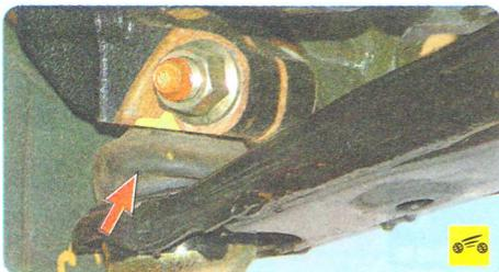
1. Проверьте состояние защитных чехлов шаровых опор. Если чехлы повреждены, замените шаровые опоры.
