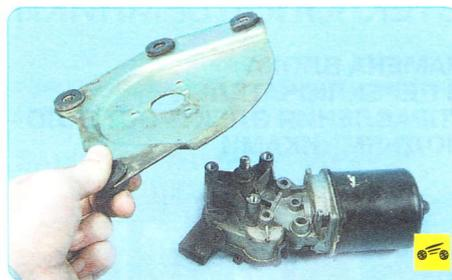
21. ...и снимите пластину трапеции стеклоочистителя с моторедуктора.
