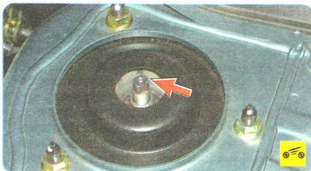
3. Осмотрите верхние опоры. В случае сильной деформации, местного выпучивания и отрыва от арматуры резинового массива опоры замените опору в сборе.
