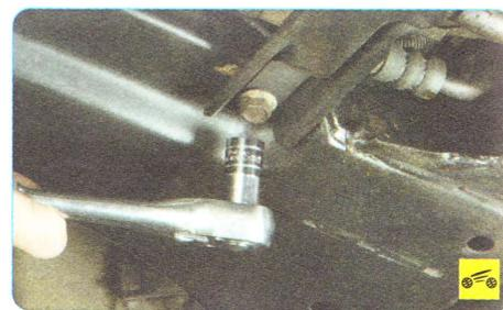
21. Выверните болт крепления защитного бруса к поперечине передней подвески...
