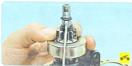
17. Поддев отверткой, снимите стопорное кольцо.
