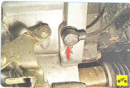
**Датчик положения коленчатого вала** индуктивного типа предназначен для синхронизации работы электронного блока управления с ВМТ поршней 1-го и 4-го цилиндров и угловым положением коленчатого вала.
