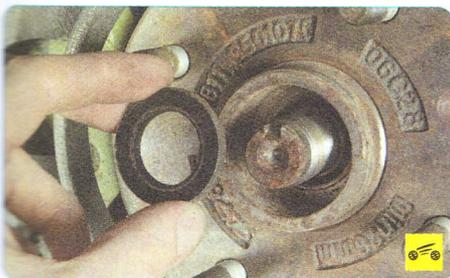
10. Отверните гайку ступицы, снимите шайбу...
