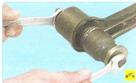
7. Выпрессуйте съемником подходящего размера сайлентблока из проушин рычага.
