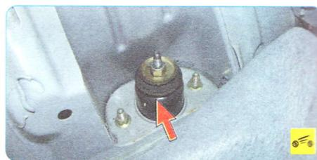
2. ...и подушки верхних шарниров амортизаторных стоек, расположенных в багажнике под обивкой.
