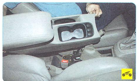
2. Снимите заднюю часть облицовки тоннеля пола (см. «Снятие и установка облицовки тоннеля пола», с. 269).
