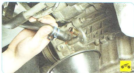
2. Снимите шланг с патрубка насоса и слейте рабочую жидкость в заранее подготовленную емкость.
