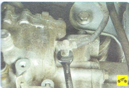
26. Выверните болт крепления клеммы «массового» провода...
