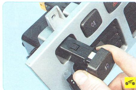
13. ...и извлеките выключатель из наклейки консоли панели приборов.
