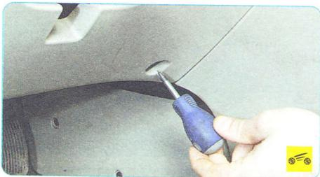
2. Выверните два винта крепления нижнего декоративного щитка панели приборов...
