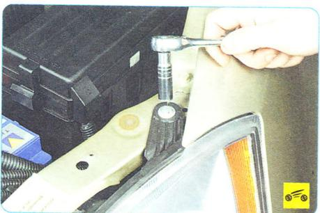
4. Выверните два болта верхнего крепления блок-фары...
