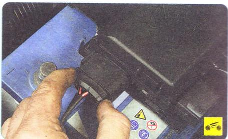
7. Нажмите на колодку жгута проводов блока силовых предохранителей...
