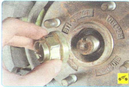
6. Окончательно отверните гайку ступицы...
