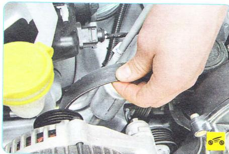
6. Снимите ремень привода вспомогательных агрегатов (см. «Проверка и замена ремня привода вспомогательных агрегатов», с. 70).
