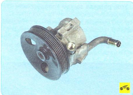
Давление рабочей жидкости в гидроусилителе создается механическим насосом лопастного типа, который установлен на двигателе, с приводом от ремня вспомогательных агрегатов. При отказе усилителя рулевого управления возможность управления автомобилем сохраняется, но усилие на рулевом колесе возрастает.
