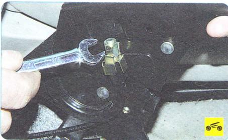
3. Отверните регулировочную гайку до конца резьбовой части наконечника переднего троса стояночного тормоза...
