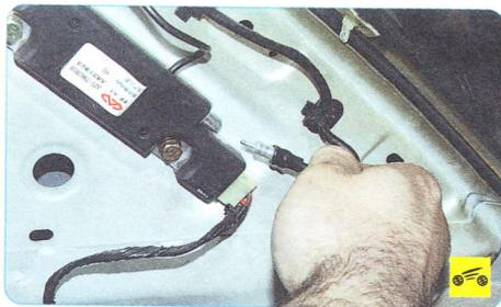
5. Отсоедините штекер антенного кабеля от вывода блока антенны.
