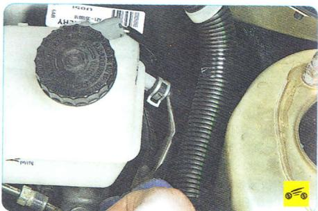
5. Сожмите пассатижами отогнутые ушки хомута крепления шланга, соединенного с главным цилиндром привода выключения сцепления...
