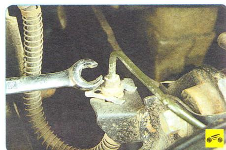
5. Выверните гайку трубки из нижнего наконечника верхнего шланга...
