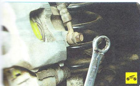
2. Для замены нижнего тормозного шланга ослабьте затяжку болта-штуцера крепления наконечника тормозного шланга к суппорту...
