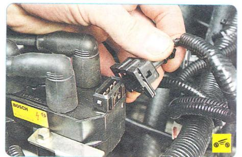
3. Нажмите на фиксатор и отсоедините подложку жгута проводов от катушки зажигания.
