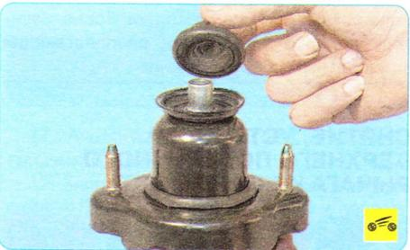
10. Снимите с верхней опоры верхнюю подушку амортизатора...
