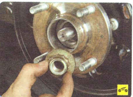
6. Отверните и снимите гайку крепления ступицы заднего колеса...
