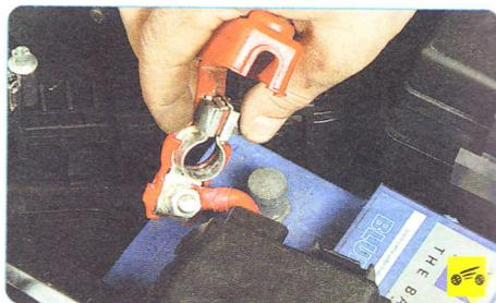
6. ...и снимите клемму с вывода аккумуляторной батареи.
