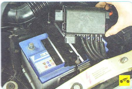
10. ...и снимите его с кронштейна крепления аккумуляторной батареи.
