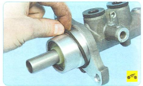
12. Снимите с корпуса главного тормозного цилиндра резиновое уплотнительное кольцо.
