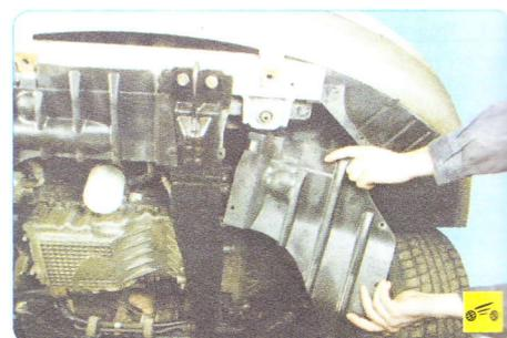
19. Снимите брызговик и защиту картера двигателя при ее наличии (см. «Снятие и установка брызговиков и защиты картера двигателя», с. 66).
