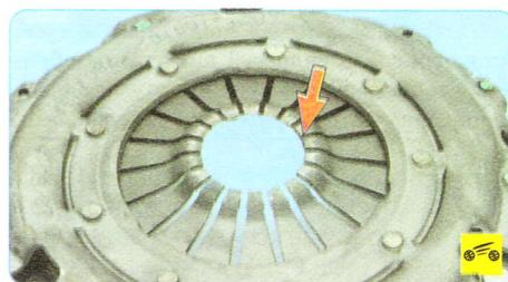
10 Внешним осмотром оцените состояние диафрагменной пружины нажимного диска. Наличие трещин на диафрагменной пружине не допускается. Места контакта лепестков пружины с подшипником выключения сцепления должны находиться в одной плоскости и не иметь явных следов износа (износ должен быть не более 0,8 мм). В противном случае замените нажимной диск в сборе.
