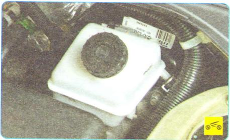
Во время прокачки гидропривода периодически проверяйте уровень жидкости в бачке главного цилиндра сцепления. Не допускайте падения уровня жидкости в бачке ниже метки «MIN» на стенке бачка. Своевременно доливайте жидкость, иначе при осушении дна бачка в систему попадет воздух и прокачку придется повторять заново.
