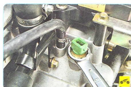
5. ...ослабьте затяжку датчика температуры охлаждающей жидкости...
