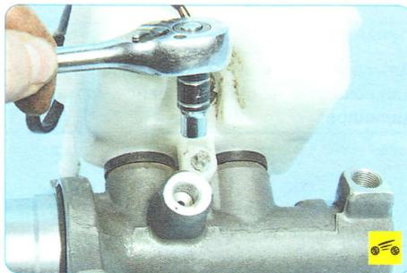
8. Если на новом главном тормозном цилиндре нет бачка или возникла необходимость замены резиновых соединительных втулок бачка, выверните винт крепления бачка к главному тормозному цилиндру...
