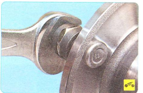
5. Запрессуйте новую втулку в ступицу с помощью гайки крепления колеса, навинченной обратной стороной, и втулки подходящего размера.
