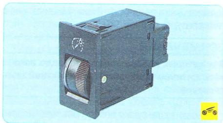
13. ...сожмите фиксаторы блока управления освещением панели приборов и извлеките выключатель из декоративного щитка.
