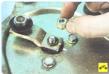
17. ...отверните гайку крепления кривошипа...
