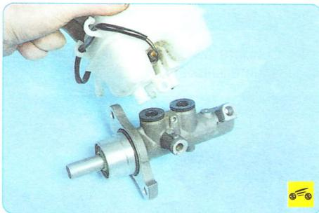
10. ...и снимите бачок, извлекая его патрубки из соединительных втулок.
