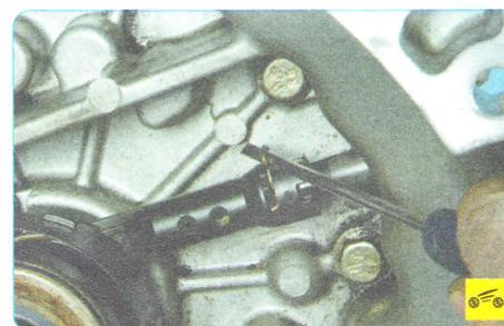
18. Поддев отверткой, приподнимите вверх пружинный фиксатор на хвостовике рабочего цилиндра привода выключения сцепления.
