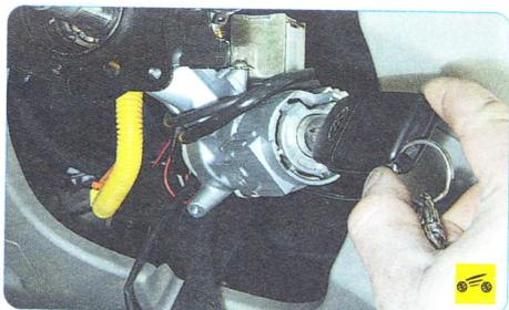
3. Вставьте ключ в замок зажигания...
