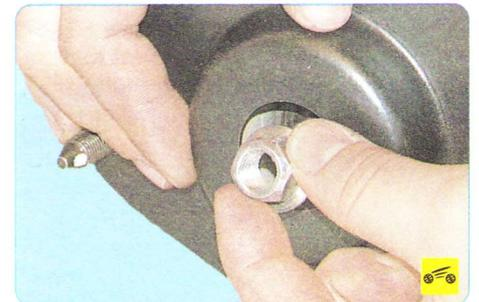
3. Отверните гайку штока амортизатора.
