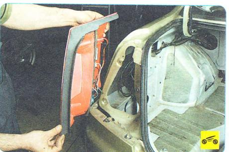
4. ...и выньте фонарь из отверстия в панели кузова.
