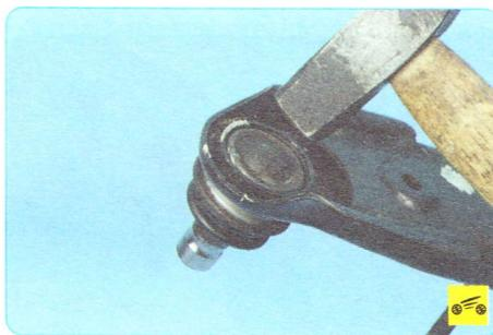
4. Выбейте шаровую опору из рычага...
