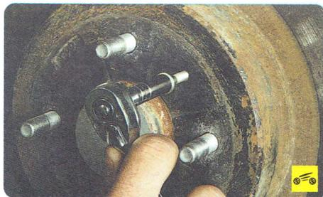
**Если диск не удается снять со ступицы руками, установите болт в дополнительное резьбовое отверстие в диске и, вворачивая его, спрессуйте диск со ступицы.**
