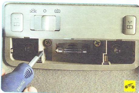
4. ...выверните два винта крепления плафона...
