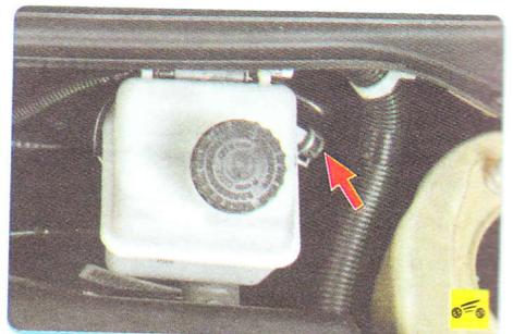
Главный цилиндр соединен шлангом с бачком, установленным на главном тормозном
