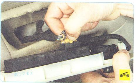
4. Нажмите на фиксатор колодки жгута проводов...
