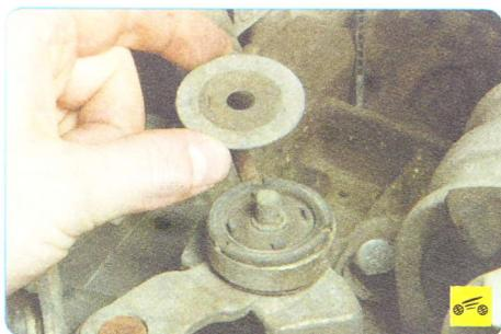
9. ...снимите с пальца рычага шайбу...
