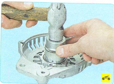
24. Запрессуйте новый подшипник в крышку оправкой подходящего диаметра, прикладывая усилие к наружному кольцу.
