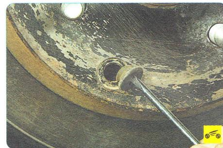
25. Установите тормозной диск, поверните его так, чтобы регулировочное отверстие
