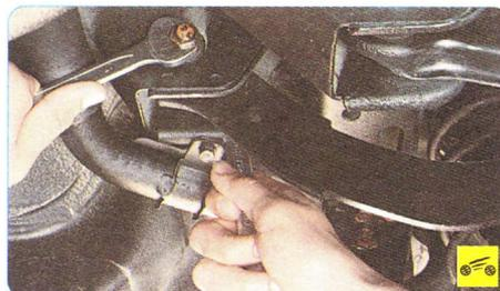
3. Отверните гайку болта крепления переднего нижнего рычага к кронштейну на кузове, извлеките болт...
