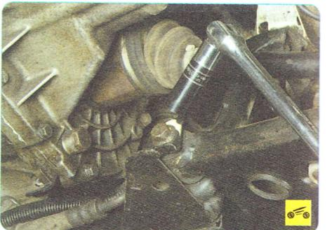
7. Ослабьте затяжку переднего болта крепления рычага подвески к поперечине...
