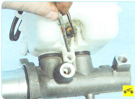
12. ...и извлеките его из отверстий бачка и главного тормозного цилиндра.
