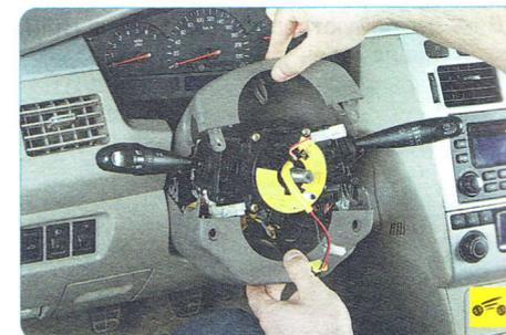
4. Разъедините верхнюю и нижнюю части кожуха рулевой колонки и снимите их в отдельности.
