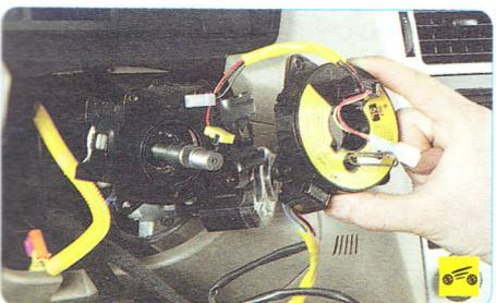
5. Снимите контактное кольцо звукового сигнала и подушки безопасности водителя (см. «Снятие и установка подушки безопасности водителя», с. 301).
