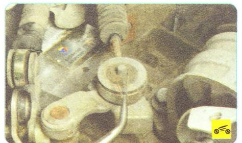
8. Извлеките пассатижами пружинный шплинт из отверстия пальца рычага переключения передач...
