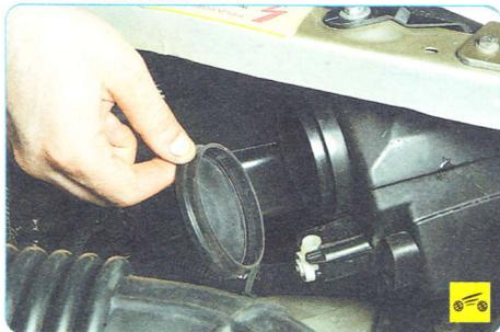
2. Снимите крышку лампы.
