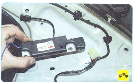
8. ...и снимите блок антенны.
