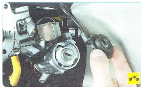
12. Снимите с выключателя зажигания антенный блок иммобилайзера.
