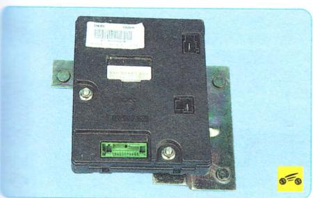
13. ...и снимите блок управления освещением.
