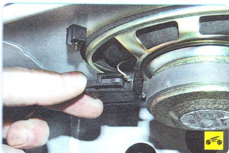
14. Откройте багажник, нажмите на фиксатор колодки жгута проводов динамика с соответствующей стороны...
