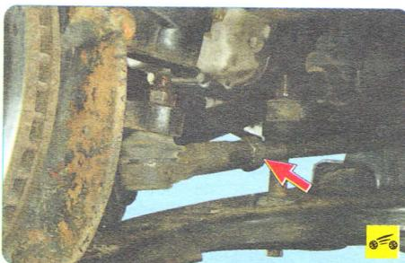
**Схождение передних колес** представляет собой угол между плоскостью вращения переднего колеса и продольной осью автомобиля. Схождение передних колес регулируют изменением длины рулевых тяг.
