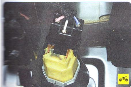
2. Под панелью приборов отсоедините колодку жгута проводов от выключателя стоп-сигналов.
