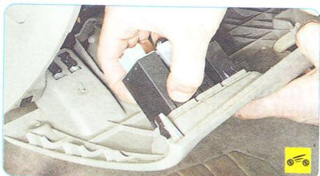
6. ...сожмите пластмассовые фиксаторы выключателя замка багажника...
