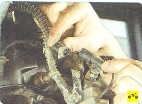
6. ...и разъедините колодку, преодолевая сопротивление ее фиксатора.
