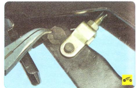
23. Снимите пружинный фиксатор пальца вилки толкателя главного цилиндра привода выключения сцепления...
