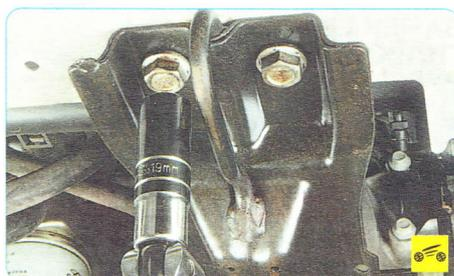
6. ...два болта его крепления к поперечине кузова...
