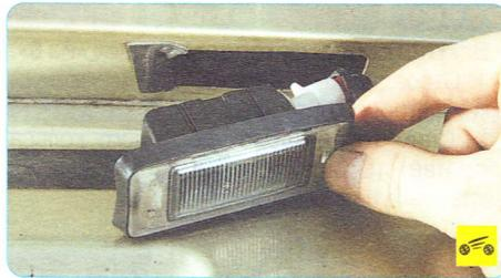
1. Подденьте фонарь освещения номерного знака и извлеките его из крышки багажника...
