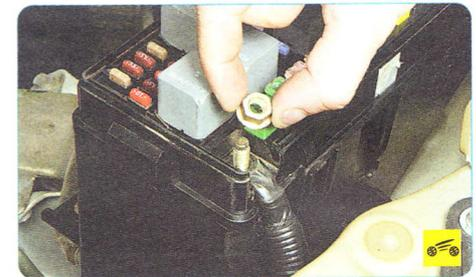
3. Отверните гайку шпильки крепления клеммы «плюсового» провода...
