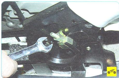
5. Заверните регулировочную гайку до момента полного затормаживания задних колес.
