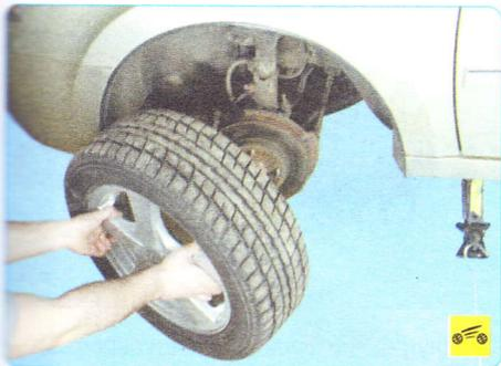
3. Снимите переднее колесо со стороны заменяемого привода (см. «Замена колеса», с. 53).
