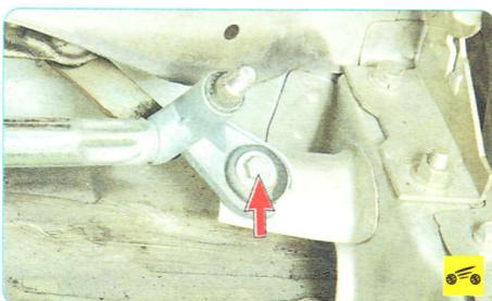
6. Выверните болт левого крепления трапеции стеклоочистителя...
