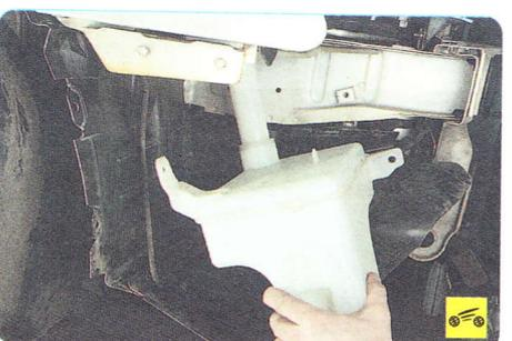
11. ...и снимите бачок омывателя в сборе с наливной горловиной.
