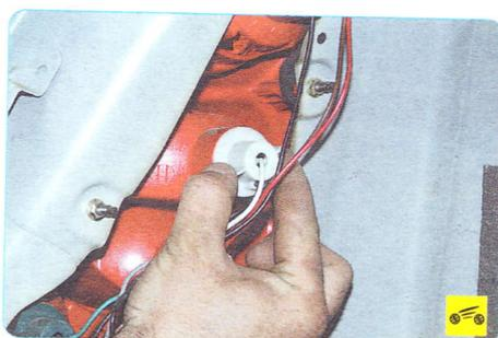
2. Поверните против часовой стрелки патрон лампы указателя поворота...
