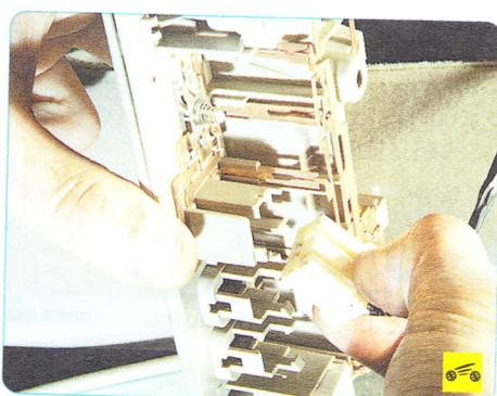
6. Отсоедините от плафона колодку жгута проводов и снимите плафон.
