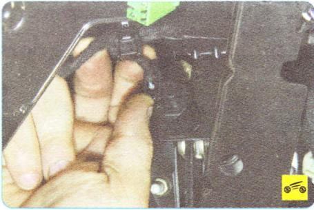
13. Сожмите фиксаторы колодки жгута проводов датчика положения педали сцепления...
