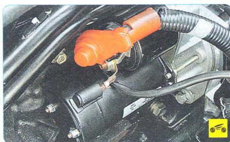
3. Откройте защитную крышку клеммы силового провода.
