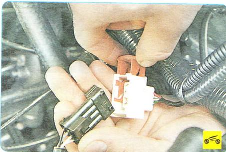
3. Отожмите фиксатор и разъедините колодку датчика концентрации кислорода.
