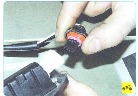
4. Нажмите на фиксатор и отсоедините от выводов указателя колодку жгута проводов.
