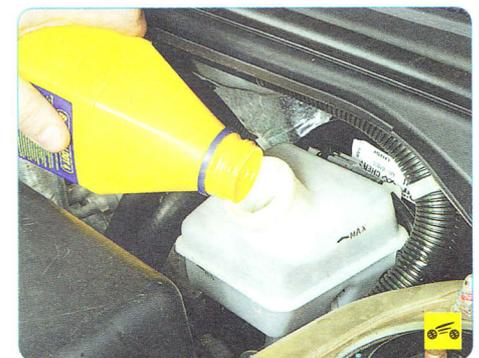
2. Долейте в бачок чистую тормозную жидкость до нижней кромки наливной горловины.
