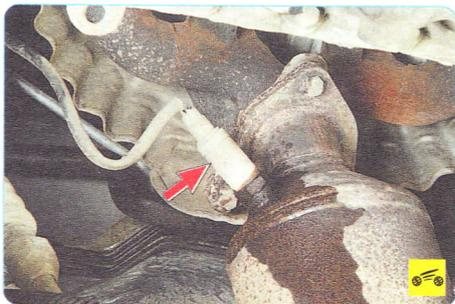
**Датчик концентрации кислорода** в отработавших газах установлен в приемной трубе нейтрализатора и служит для управления составом топливовоздушной смеси. В металлической колбе датчика расположен гальванический элемент, омываемый потоком отработавших газов. В зависимости от содержания кислорода в отработавших газах в результате сгорания топливовоздушной смеси изменяется напряжение сигнала датчика.
