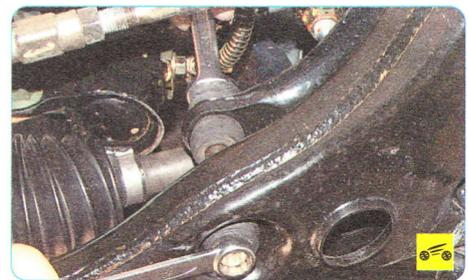
1. Отверните гайку болта крепления стойки стабилизатора поперечной устойчивости к штанге стабилизатора.
