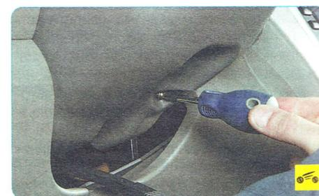
3. Опустите вниз рычаг регулировки положения рулевой колонки и выверните нижний винт крепления кожуха.
