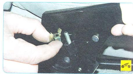
9. ...и ее пружинный фиксатор.
