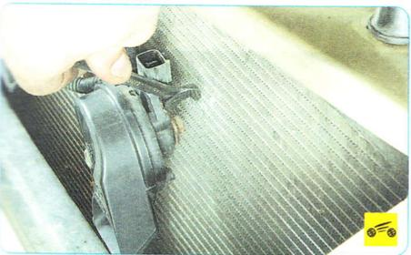
5. Отверните гайку крепления звукового сигнала...
