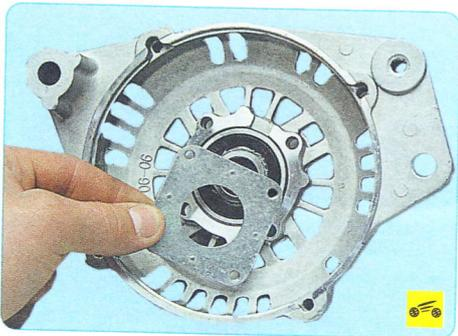
22. ...и снимите пластину.
