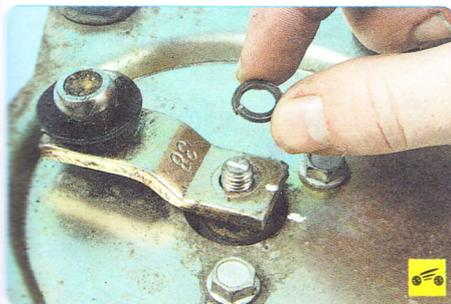
18. ...снимите пружинную шайбу...
