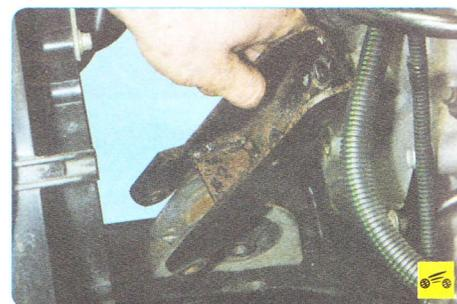
20. Снимите кронштейн передней опоры подвески силового агрегата (см. «Замена передней опоры подвески силового агрегата», с. 68).
