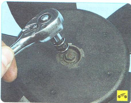
7. При необходимости снятия с электродвигателей крыльчаток вентиляторов отверните гайки крепления крыльчаток и снимите их с валов электродвигателей.
