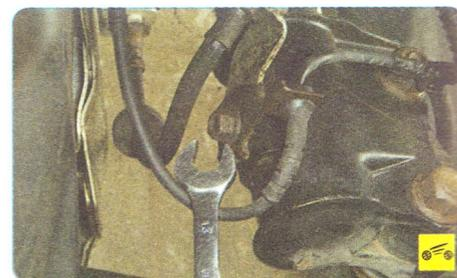
5. Отверните гайку крепления кронштейна тормозного шланга и жгута проводов датчика частоты вращения колеса к амортизаторной стойке передней подвески...
