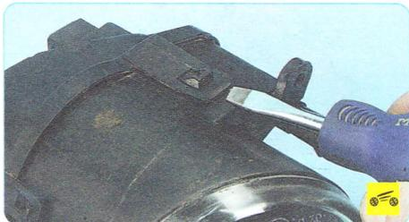
2. Подденьте пластмассовые фиксаторы крышки противотуманной фары (для наглядности эта и последующие операции показаны на снятой фаре)...
