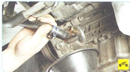
4. Снимите шланг с патрубка насоса и слейте рабочую жидкость в заранее подготовленную емкость.
