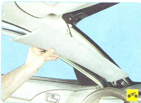
2. Для снятия и установки динамика, расположенного в передних стойках кузова, снимите облицовку передней стойки кузова с соответствующей стороны (см. «Снятие и установка облицовок салона», с. 274).
