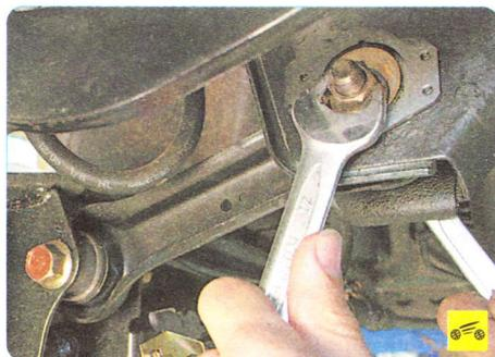
3. Отверните гайку болта крепления рычага...
