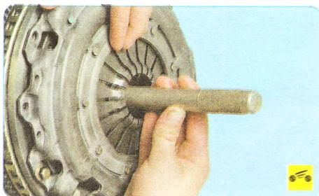
14 При монтаже сцепления сначала установите с помощью оправки ведомый диск.
