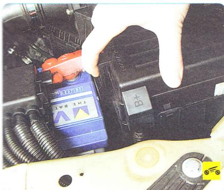
1. Для доступа к предохранителям и реле монтажного блока, расположенного в подкапотном пространстве, нажмите на пластмассовые фиксаторы крышки блока...
