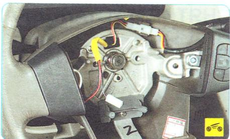
3. Извлеките из пластмассового держателя на рулевом колесе колодку жгута проводов блока управления аудиосистемой...
