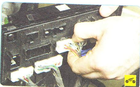
10. Нажмите на фиксатор второй колодки второго ряда жгута проводов электрооборудования...
