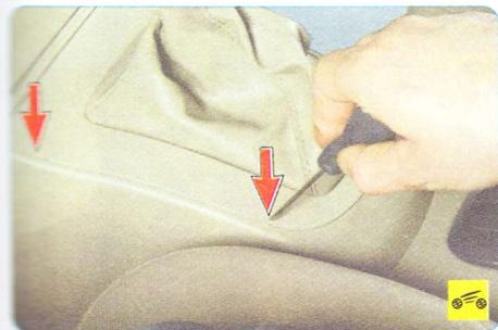
1. Отожмите отверткой два пружинных фиксатора с левой стороны рамки чехла управления коробкой передач...
