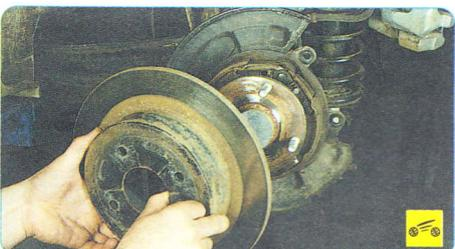
4. Снимите тормозной диск (см. «Замена тормозного диска тормозного механизма заднего колеса», с. 188).
