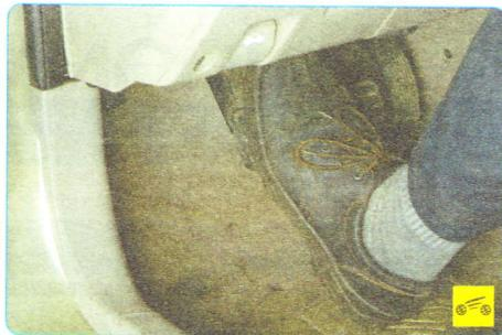
4. Попросите помощника нажать на педаль сцепления четыре-пять раз с интервалами 2–3 с, а затем удерживать ее нажатой.
