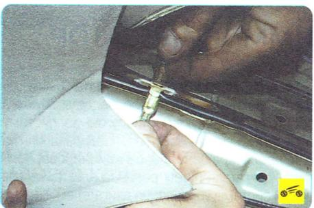
4. Немного отогните обивку потолка и отсоедините клемму голубого провода от вывода антенны на заднем стекле.
