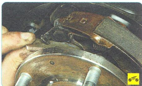
13. Сдвинув распорную планку вниз, отсоедините ее от длинного отогнутого конца верхней стяжной пружины задней тормозной колодки...
