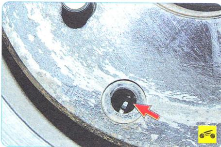
Так расположен зубчатый венец регулировочного устройства.
