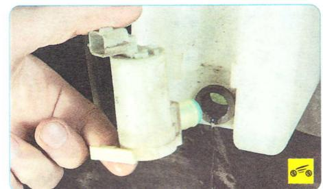
6. При необходимости замены насоса извлеките его из отверстия в бачке.
