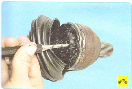
5. ...и сбейте с вала молотком через бородок обойму шарнира, преодолевая усилие стопорного кольца.
