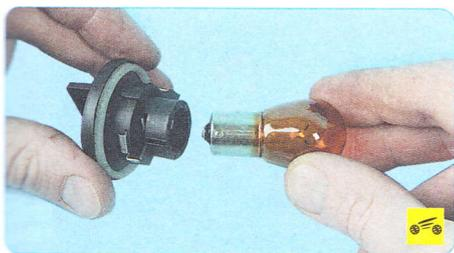
4. Выньте лампу из патрона, провернув ее против часовой стрелки.
