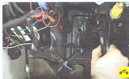
7. Снимите педаль тормоза, сдвинув ее с четырех шпилек нижнего крепления и затем приподняв настолько, чтобы незамкнутые отверстия в кронштейне оказались выше двух гаек верхнего крепления (если эти гайки не отвернули полностью).
