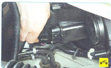
3. Отсоедините колодки жгутов проводов от выводов ламп блок-фары и электрокорректора фар.
