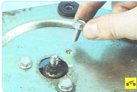
20. Выверните три болта крепления моторедуктора к пластине трапеции...
