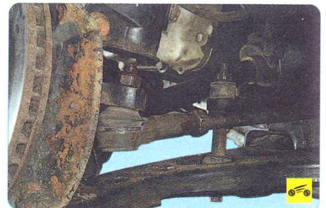
1. Проверьте состояние защитных чехлов наконечников рулевых тяг. Замените порванные, потрескавшиеся или потерявшие эластичность чехлы.
