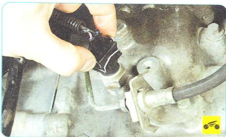
2. Нажмите на фиксаторы колодки жгута проводов выключателя света заднего хода...
