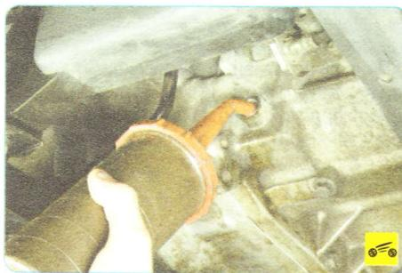
3. Если уровень масла сильно понижен (не удается проконтролировать), залейте масло шприцем в отверстие до нижней кромки контрольного отверстия. Заверните пробку контрольного отверстия и удалите потеки масла.
