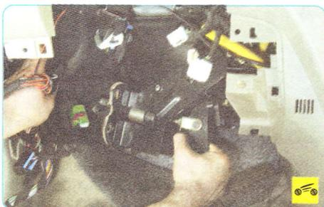
17. ...снимите педаль в сборе с главным цилиндром привода выключения сцепления, пропустив шланги цилиндра через отверстия уплотнителя в щите передка кузова.
