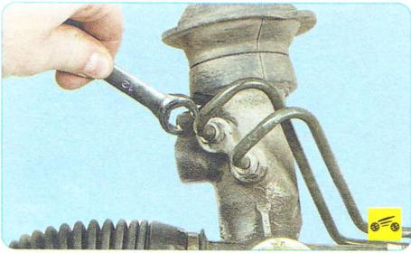
27. При необходимости замены трубопроводов рулевого механизма отверните гайки их крепления к распределителю...
