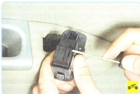
14. ...нажмите на фиксатор колодки жгута проводов...
