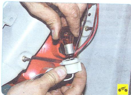
4. Поверните лампу в патроне против часовой стрелки и извлеките ее из патрона.
