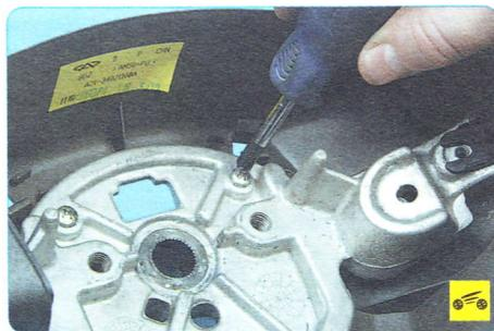
10. Выверните два винта крепления кожуха рулевого колеса к ступице...
