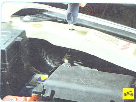
8. Откройте капот и, вращая отверткой зубчатые колеса регулировочных винтов, отрегулируйте положение на экране светового пятна для каждой фары по вертикали...
