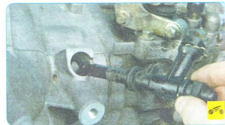
20. ...и извлеките переходник из отверстия в картере сцепления.
