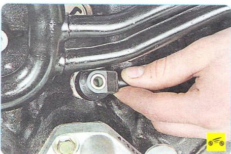
4. ...и снимите датчик детонации.
