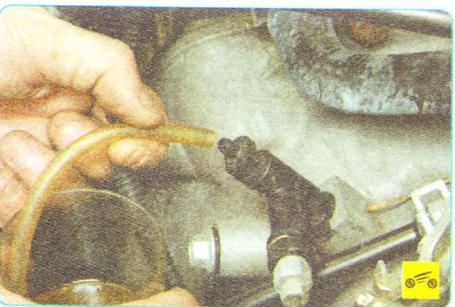
3. Наденьте на клапан шланг и опустите его конец в емкость с небольшим количеством тормозной жидкости.
