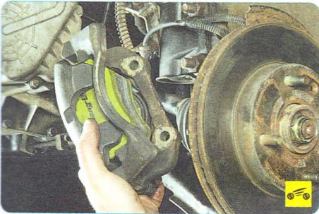
4. Снимите суппорт в сборе с направляющей колодок (см. «Замена суппорта тормозного механизма переднего колеса», с. 187), не отсоединяя от него тормозной шланг...
