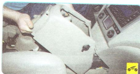
1. Снимите облицовку тоннеля пола (см. «Снятие и установка облицовки тоннеля пола», с. 269).
