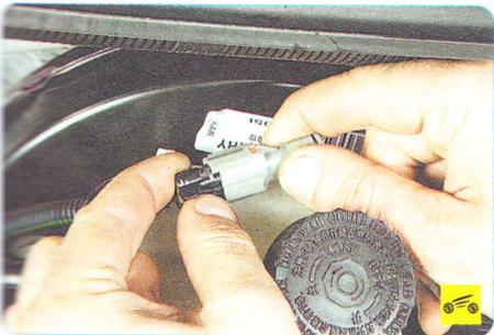
9 Нажмите на фиксатор колодки жгута проводов датчика...
