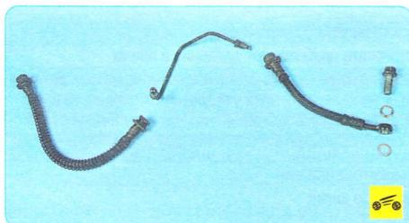
**Гидравлическая система тормозов** объединена в единое целое металлическими трубками и шлангами. Система заполнена специальной тормозной жидкостью DOT-4.
