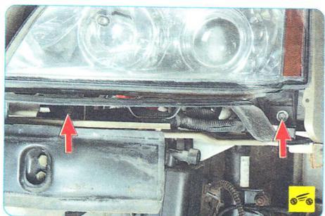
5. ...два болта нижнего крепления блок-фары...
