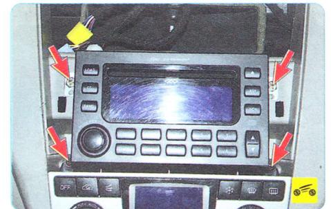
3. Выверните четыре винта крепления автомагнитолы...
