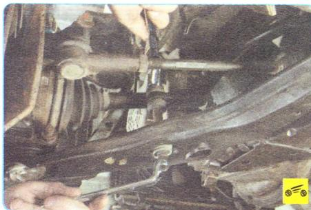
8. Ослабьте затяжку гайки болта стойки стабилизатора поперечной устойчивости передней подвески, удерживая болт от проворачивания вторым ключом...
