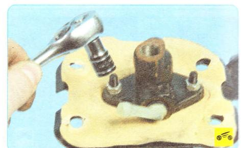
25. Отверните две гайки крепления главного цилиндра привода выключения сцепления к кронштейну педали...
