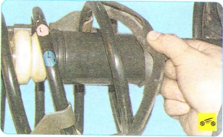
7. ...и нижнюю резиновую прокладку пружины. Внимательно осмотрите прокладки пружины и, если они обжаты, затвердели или надорваны, замените их.
