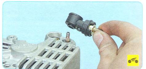
18... и снимите с болта изоляционную втулку с контактной шпилькой.
