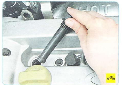
2. Снимите наконечник высоковольтного провода с заменяемой свечи.
