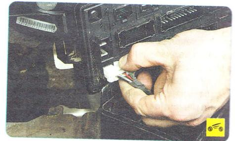
18. Нажмите на фиксатор первой колодки третьего ряда жгута проводов электрооборудования...
