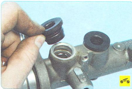
14. Если в процессе эксплуатации наблюдалась утечка тормозной жидкости через соединительные втулки, извлеките втулки из отверстий корпуса цилиндра. Для этого, поддев отверткой край втулки, извлеките ее из отверстия главного тормозного цилиндра.
