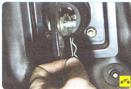
6. Извлеките пружинный шплинт пальца вилки толкателя вакуумного усилителя тормозов...
