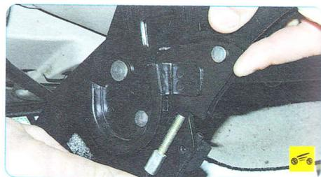
10. Извлеките наконечник троса из корпуса рычага привода стояночного тормоза...
