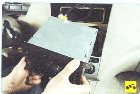
2. Снимите автомагнитолу (см. «Снятие и установка автомагнитолы», с. 235).
