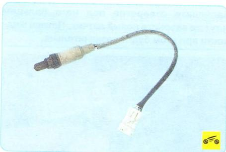
6. Установите датчик концентрации кислорода в порядке, обратном снятию.
