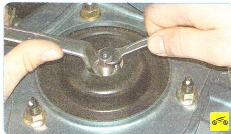
3. Откройте капот и, удерживая ключом шток амортизатора от проворачивания, вторым ключом ослабьте затяжку гайки крепления опоры амортизаторной стойки.
