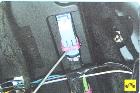
4. Нажмите на пластмассовый фиксатор держателя голубой колодки жгута проводов...
