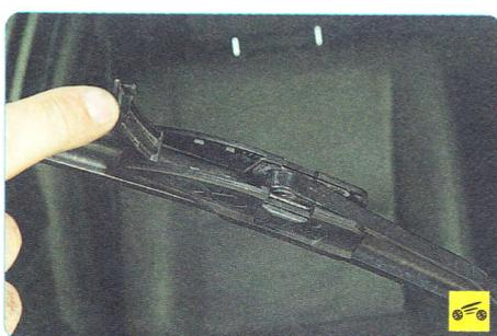
2. ...отогните фиксатор щетки...
