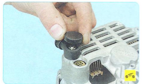
16. ...снимите крышку контактного болта...
