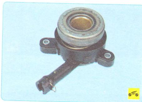
...рабочий цилиндр 3 (см. рис. 6.1), объединенный с подшипником 2 выключения сцепления...
