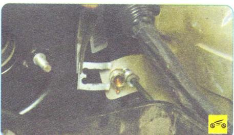
8. Снимите пружинную скобу крепления наконечника шланга...
