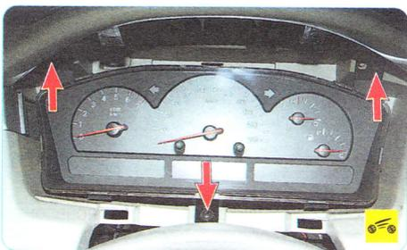
4. Выверните три винта крепления комбинации приборов к панели приборов...
