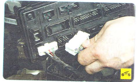
17. ...и отсоедините колодку от выводов монтажного блока.
