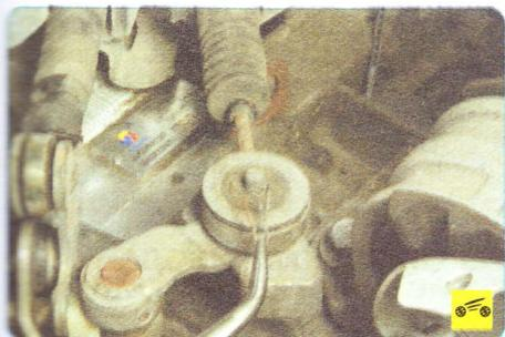
9. В подкапотном пространстве извлеките пассатижами пружинный шплинт из отверстия пальца рычага переключения передач...
