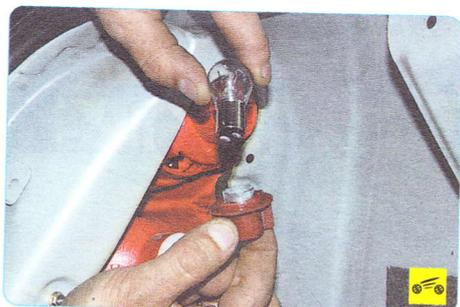
4. Поверните лампу в патроне против часовой стрелки и извлеките ее из патрона.
