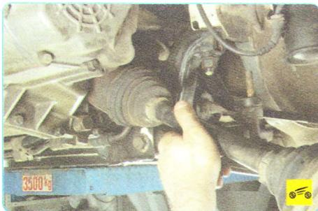
16. ...и снимите привод переднего колеса в сборе.
