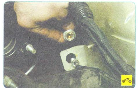
9. ...и извлеките наконечник из отверстия кронштейна на кузове.
