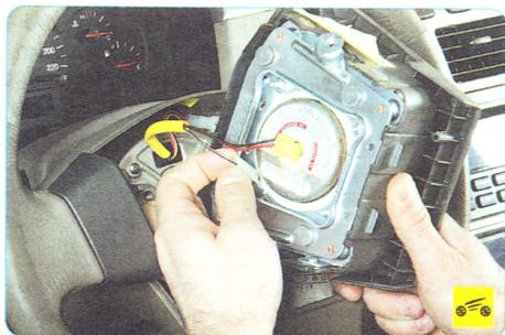
2. Снимите подушку безопасности водителя (см. «Снятие и установка подушки безопасности водителя», с. 301).
