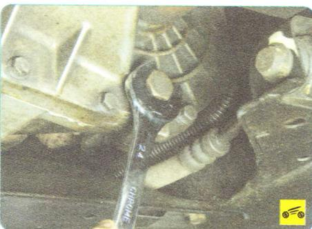
4. Для замены масла в коробке передач выверните пробку сливного отверстия...
