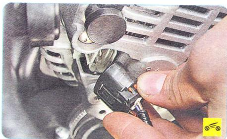
5. Сожмите фиксаторы и отсоедините от генератора колодку жгута проводов.
