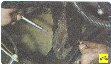
4. ...и извлеките болт крепления передней опоры подвески силового агрегата к кронштейну двигателя.
