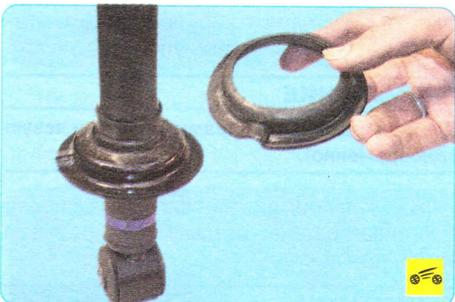
9. Снимите нижнюю прокладку пружины.
