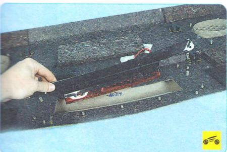
5. ...и снимите дополнительный стоп-сигнал.
