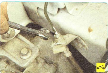
3. Выверните вторую гайку верхней трубки из верхнего наконечника переднего шланга...
