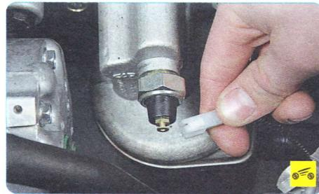
2. Отсоедините от вывода датчика колодку с проводом...
