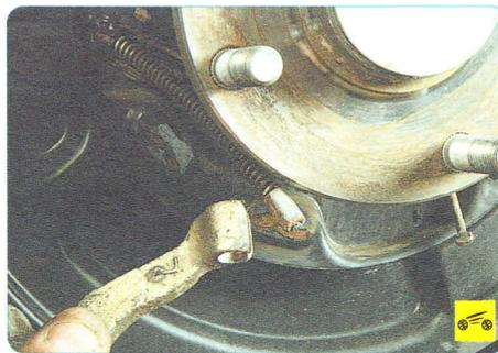
21. ...и, отсоединив наконечник троса от распорного рычага, снимите рычаг.
