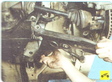
11. ...и снимите рычаг.
