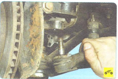
4. Отсоедините наружные наконечники рулевых тяг от поворотных кулаков (см. «Замена наружного наконечника рулевой тяги», с. 166).
