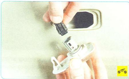
4. Сожмите фиксатор и отсоедините от выводов указателя колодку жгута проводов.
