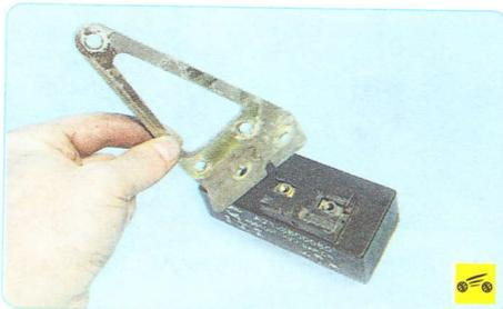
7. ...и снимите кронштейн с дополнительного сопротивления.
