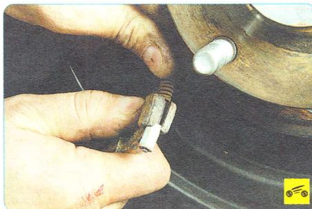
20. ...отожмите рычагом распорную пружину заднего троса привода стояночного тормоза...
