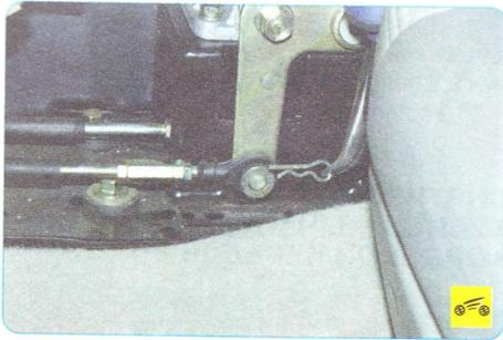
3. ...извлеките его из отверстия пальца рычага выбора передач.
