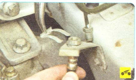
5. Снимите пружинную скобу крепления наконечника шланга...
