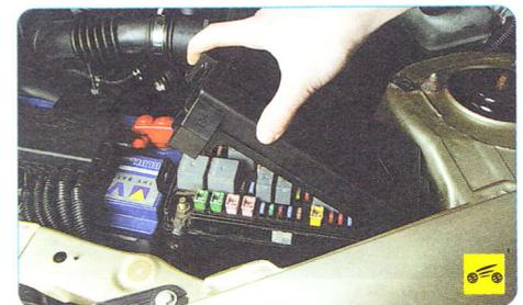
2. Снимите крышку блока предохранителей (см. «Расположение предохранителей и реле и их замена», с. 199).
