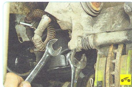
8. Ослабьте затяжку болта крепления верхнего направляющего пальца суппорта, удерживая палец от проворачивания вторым ключом...
