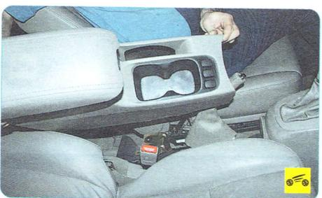
1. В салоне автомобиля снимите заднюю часть облицовки тоннеля пола (см. «Снятие и установка облицовки тоннеля пола», с. 269).
