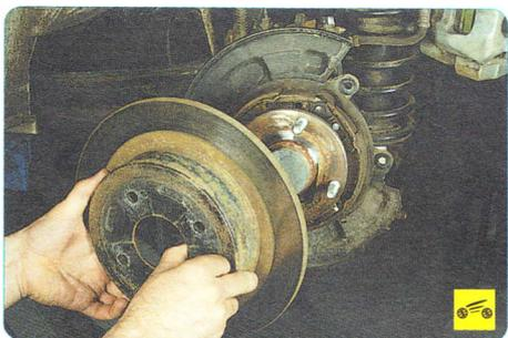
2. Снимите тормозной диск (см. «Замена тормозного диска тормозного механизма заднего колеса», с. 188).
