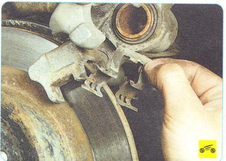
11. ...и верхнюю прижимные пружины колодок и осмотрите их. Сильно корродированные или деформированные пружины замените.
