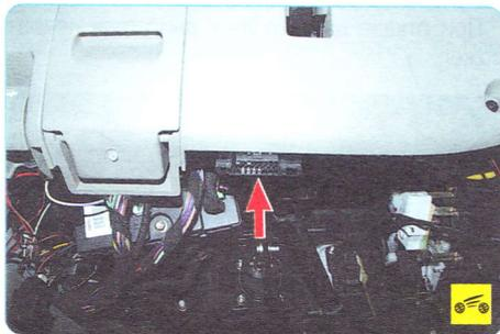
**Диагностический разъем** служит для вывода из памяти контроллера кодов неисправностей, выявленных при работе системы управления двигателем.
