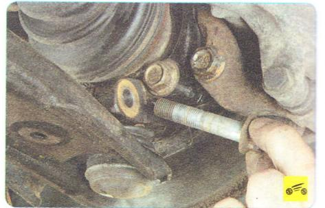
5. ...извлеките болт из отверстий поворотного кулака...
