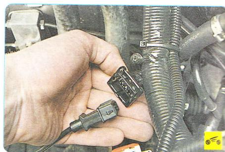
2. Разъедините колодку жгута проводов датчика.
