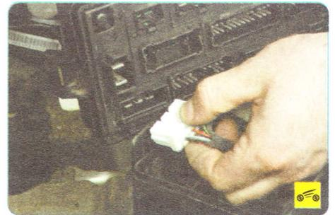
5. Снимите монтажный блок...
