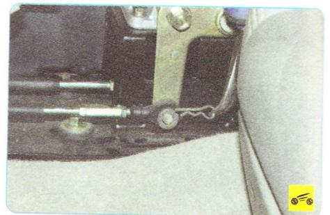
3. ...извлеките его из отверстия пальца рычага выбора передач.
