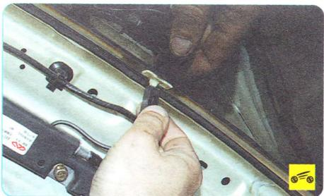
3. Отсоедините клемму черного провода от вывода антенны на заднем стекле.
