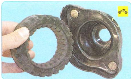
12. ...и снимите верхнюю прокладку пружины.
