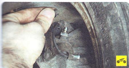
7. Снимите защитные колпачки и проверьте на отсутствие утечек клапаны для выпуска воздуха тормозных механизмов передних и задних колес.
