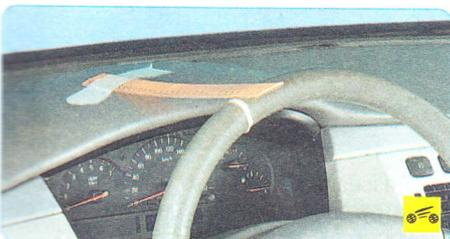
2. Установите линейку так, чтобы ее передний конец был неподвижно зафиксирован на панели приборов, а плоскость линейки касалась наружной поверхности обода рулевого колеса. Не меняя положения линейки, поверните рулевое колесо вправо до момента начала поворота передних колес. В этом положении нанесите на обод рулевого колеса метку.
