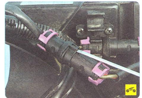
4. ...и, поддев фиксаторы колодок отверткой, разъедините их.
