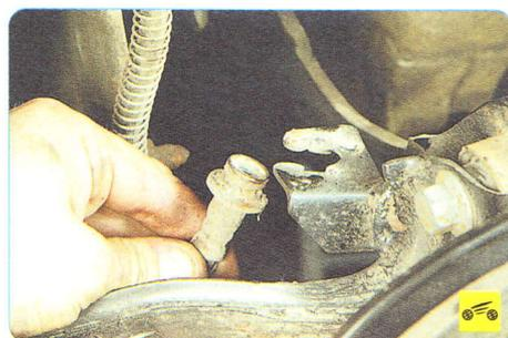
18. ...выньте верхний наконечник шланга из отверстия кронштейна на рычаге задней подвески...
