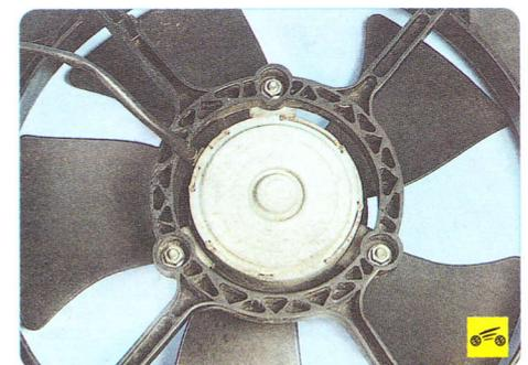
5. Выверните по три гайки крепления электровентиляторов...
