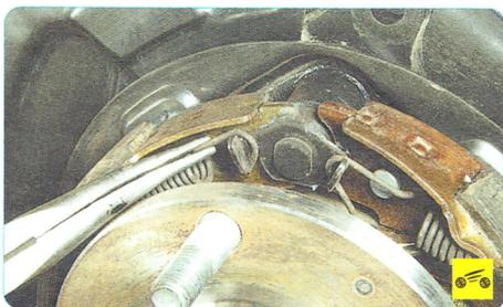
6. Захватив пассатижами с тонкими губками отогнутый конец верхней стяжной пружины передней колодки...
