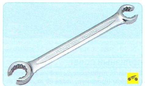
...и специальный ключ «на 11» для тормозных трубопроводов.
