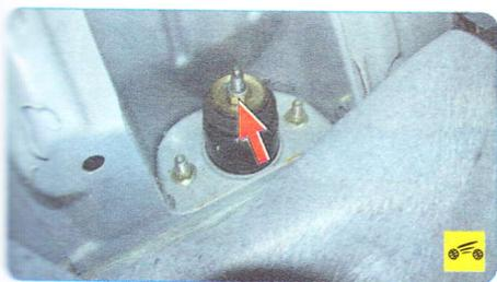
4. ...ослабьте затяжку гайки штока амортизаторной стойки, удерживая шток от проворачивания вторым ключом...
