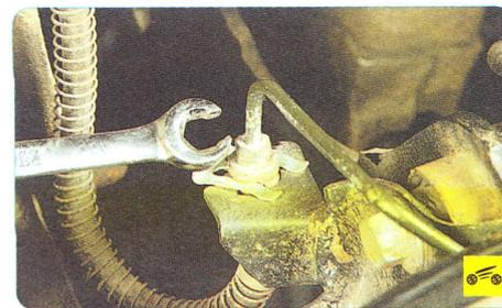
14. Выверните гайку трубки из нижнего наконечника шланга...
