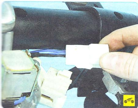
4. Снимите колодку жгута проводов соленоида с контактной группы выключателя (замка) зажигания...
