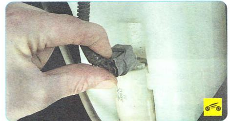
3. Нажмите на фиксатор колодки жгута проводов насоса омывателя...
