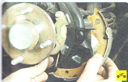
18. ...и снимите колодку, сняв ее с пальца разжимного рычага.
