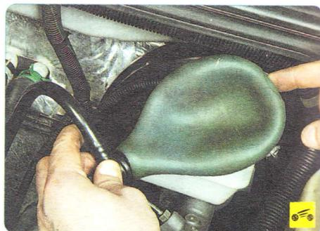
6. Отпустите грушу. Если она осталась в сжатом состоянии, значит, клапан исправен. При отсутствии груши можно продуть клапан ртом.
