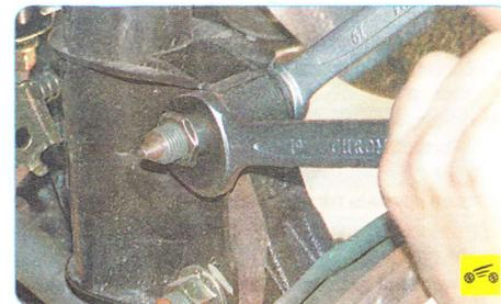
7. Отверните гайку верхнего болта крепления амортизаторной стойки к поворотному кулаку, удерживая головку болта от проворачивания...
