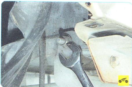
8. Отверните гайку верхнего крепления бачка омывателя.
