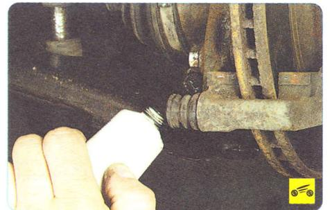
...а затем смажьте смазкой защитный чехол пальца. Аналогично смажьте второй направляющий палец и его чехол.
