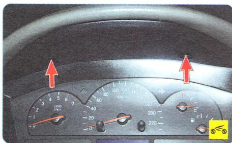
2. Выверните два винта крепления облицовки комбинации приборов...
