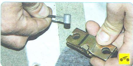
2. В салоне автомобиля отсоедините передние наконечники задних тросов привода стояночного тормоза от уравнивателя на переднем тросе привода (см. «Замена переднего троса привода стояночного тормоза», с. 194).
