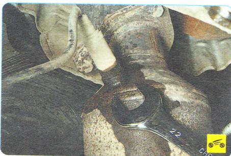
4. Ослабьте затяжку датчика концентрации кислорода...
