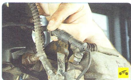
4. Извлеките из держателя колодку жгута проводов датчика износа накладки внутренней тормозной колодки...
