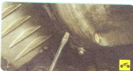
43. Вставив большую отвертку в специальный паз в нижней части картера сцепления, сдвиньте коробку передач назад до момента выхода первичного вала коробки передач из ступицы ведомого диска сцепления.
