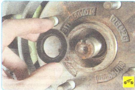
7. ...и снимите упорную шайбу.
