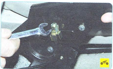
7. Отверните регулировочную гайку до конца резьбовой части наконечника переднего троса стояночного тормоза...
