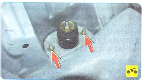
5. ...и отверните две гайки крепления опоры амортизаторной стойки.
