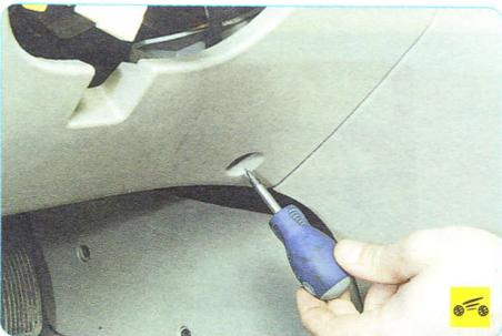
2. Выверните два винта крепления декоративного щитка панели приборов...
