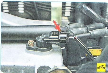
3. Сожмите фиксатор колодки жгута проводов датчика фазы...
