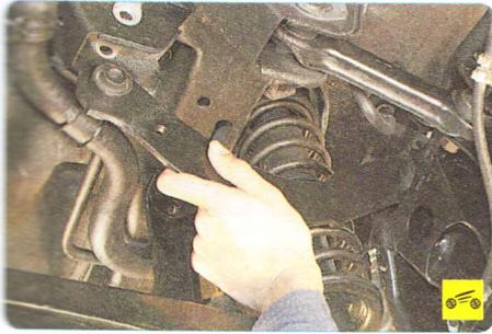
4. ...и снимите рычаг с автомобиля.
