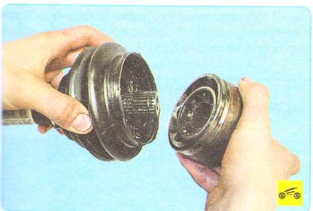
6. Снимите наружный шарнир со шлицев вала.
