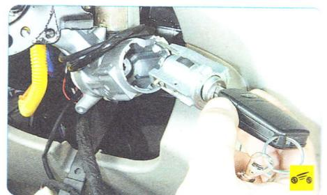
5. ...и извлеките цилиндр замка из корпуса выключателя.
