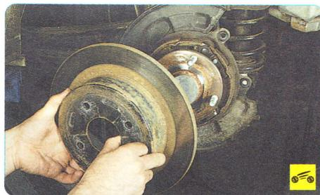
6. Снимите тормозной диск со ступицы.
