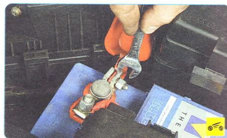
5. ...ослабьте затяжку крепления клеммы провода «плюс»...
