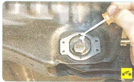
3. Пометьте положение регулировочной шайбы болта в кронштейне кузова.
