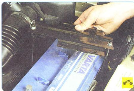
12. ...снимите стяжки в сборе с прижимной планкой крепления аккумуляторной батареи...
