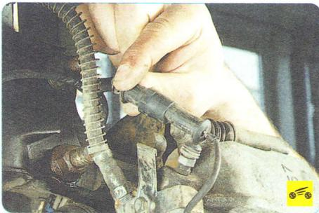
4. Извлеките из держателя колодку жгута проводов датчика износа накладки внутренней тормозной колодки...
