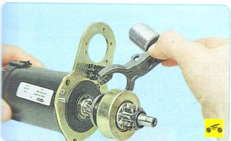
14. ...и снимите рычаг привода вместе с якорем тягового реле.
