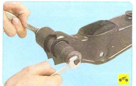
10. Выпрессуйте съемником подходящего размера наружный сайлентблок из проушины рычага.
