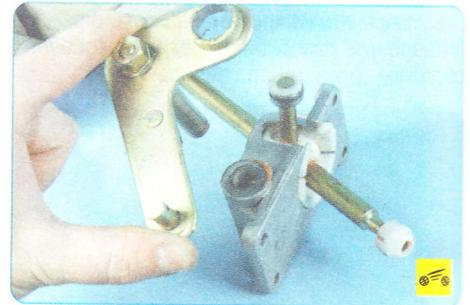
13. Извлеките ось рычага выбора передач из втулок в корпусе кулисы.
