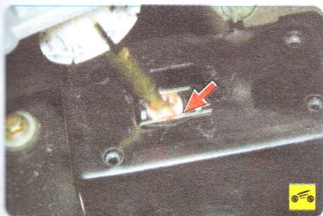
Так выглядит фиксатор наконечника троса переключения передач. Для наглядности показано при снятой кулисе рычага управления коробкой передач.
