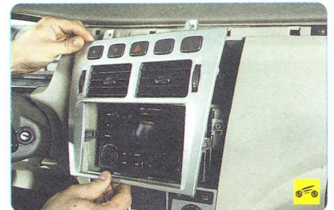
2. Снимите накладку консоли панели приборов (см. «Снятие и установка выключателей аварийной сигнализации, противотуманных фар и задних противотуманных фонарей», с. 234).
