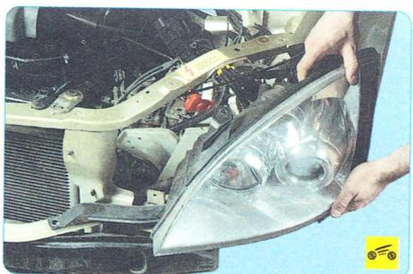
6. ...снимите блок-фару с автомобиля.
