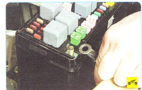
4. ...и снимите клемму со шпильки.
