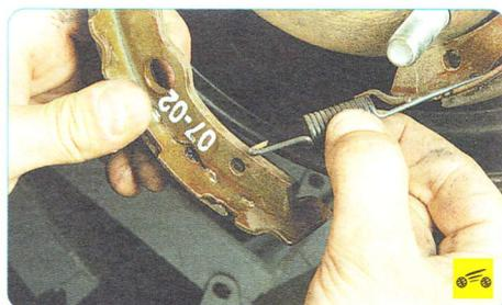
11. ...отсоедините от передней колодки нижнюю стяжную пружину и снимите колодку...
