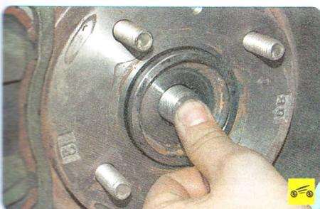
11. ...выведите хвостовик наружного шарнира равных угловых скоростей из ступицы переднего колеса, отведя амортизаторную стойку в сторону, и подвесьте привод на проволоке.
