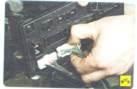
16. Нажмите на фиксатор второй колодки третьего ряда жгута проводов электрооборудования...
