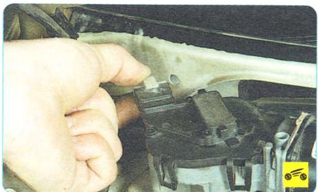
3. Нажмите на фиксатор колодки жгута проводов моторедуктора стеклоочистителя...
