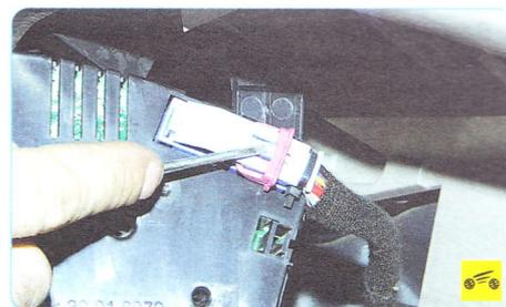
6. ...нажмите на фиксатор держателя колодки жгута проводов комбинации приборов...
