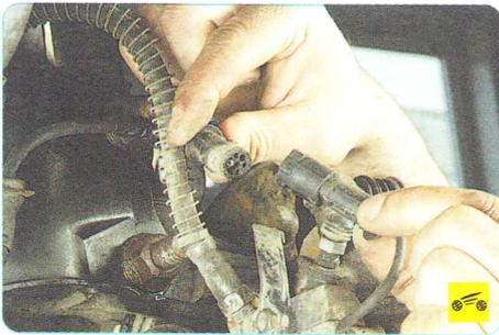
5. ...и разъедините колодку, преодолевая сопротивление ее фиксатора.
