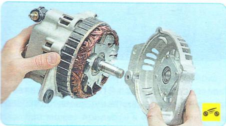
8. Поддев двумя отвертками, отделите статор от крышки со стороны привода и снимите крышку.
