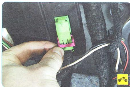
7. Нажмите на пластмассовый фиксатор держателя зеленой колодки жгута проводов...
