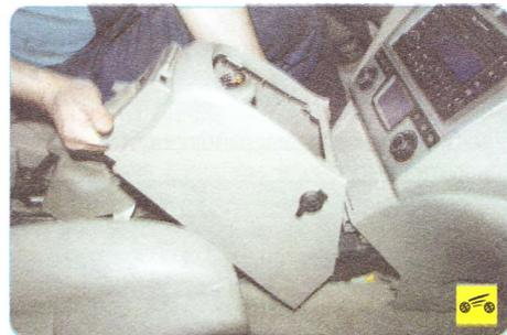
1. Снимите облицовку тоннеля пола (см. «Снятие и установка облицовки тоннеля пола», с. 269).
