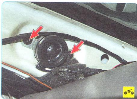
4. ...выверните два винта крепления динамика и снимите его.
