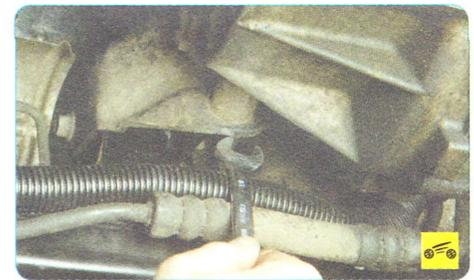
35. ...и нижний болты крепления кронштейна задней опоры подвески силового агрегата к картеру коробки передач.
