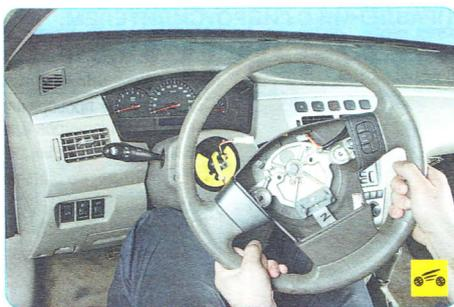
9. ...и снимите его, продев колодку жгута проводов через отверстие в ступице.
