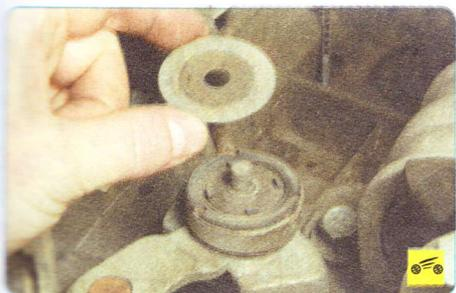
10. ...снимите с пальца рычага шайбу...
