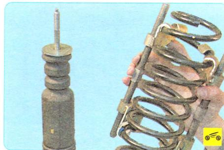
6. Снимите пружину задней подвески...
