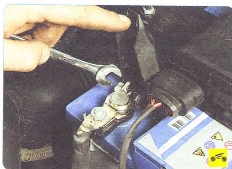
2. ...ослабьте затяжку клеммы крепления провода «минус»...
