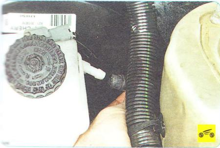
7...и снимите шланг с патрубка бачка главного тормозного цилиндра.
