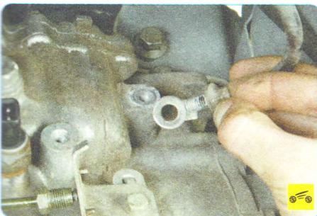
27. ...и отсоедините провод от картера коробки передач.
