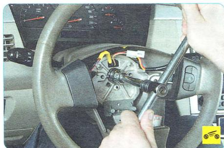
5. Отверните не до конца гайку крепления рулевого колеса к рулевому валу, удерживая рулевое колесо от проворачивания.
