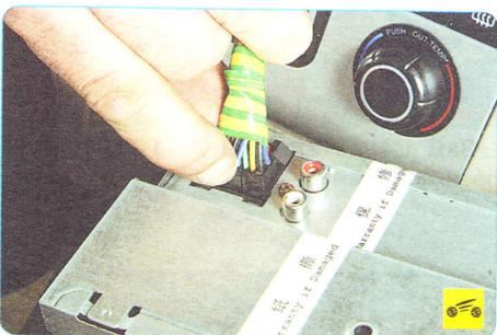
6. ...нажмите на фиксатор колодки жгута проводов магнитолы...
