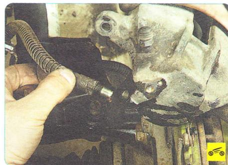
10. Снимите суппорт, свинчивая его с наконечника тормозного шланга.
