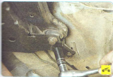
9. Ослабьте затяжку заднего болта крепления рычага...
