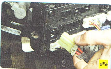
9. ...и отсоедините колодку от соответствующих выводов монтажного блока.
