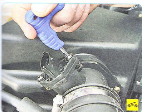
5. При отклонении сопротивления от нормы замените датчик, вывернув два винта его крепления.
