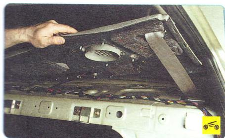
13. Для снятия и установки динамика, расположенного **в задней полке**, снимите облицовку задней полки (см. «Снятие и установка облицовок салона», с.274).
