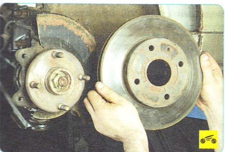
6. Снимите тормозной диск со шпилек ступицы.
