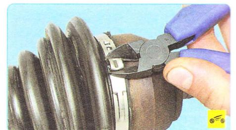
3. Для замены **наружного шарнира** и его чехла отсоедините отверткой или перекусите бокорезами замок хомута крепления большого чехла наружного шарнира и снимите хомут.
