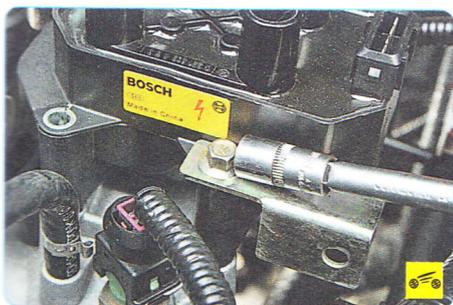
5. Выверните четыре винта крепления катушки зажигания...
