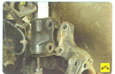
7. Отсоедините поворотный кулак от телескопической стойки (см. «Снятие и установка амортизаторной стойки передней подвески», с. 150)...
