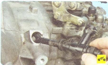
4. ...и извлеките переходник из отверстия в картере сцепления.
