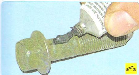
Перед установкой смажьте консистентной смазкой болты крепления амортизаторной стойки к поворотному кулаку, чтобы потом было легко их извлекать.
