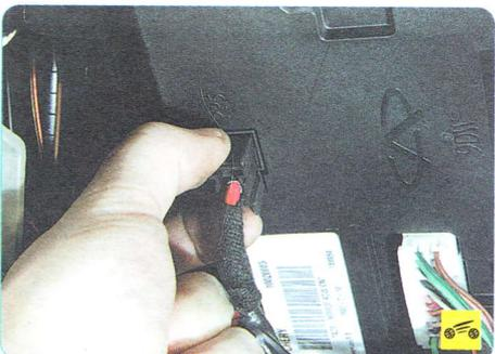
10. Нажмите на фиксатор черной колодки жгута проводов блока...
