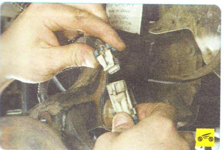
6. Разъедините колодку жгута проводов датчика частоты вращения колеса.
