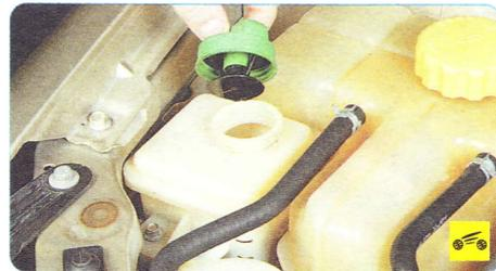
2. Отверните крышку бачка гидроусилителя рулевого управления, откачайте рабочую жидкость из бачка (например, большим шприцем) и установите крышку на место, чтобы в бачок не попала грязь.
