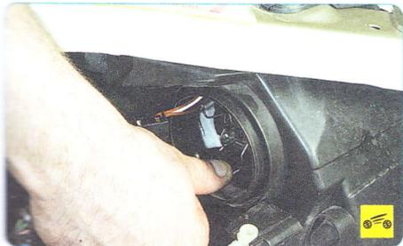
3. Выведите концы пружинного держателя из прорезей в оптическом элементе фары...
