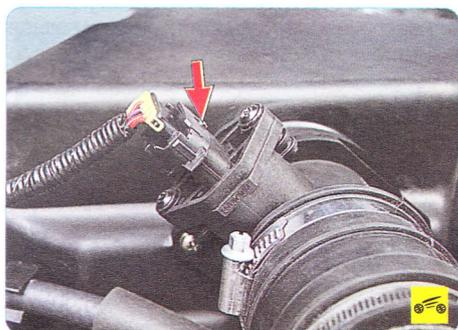
**Датчик массового расхода воздуха** расположен между воздушным фильтром и воздухоподводящим рукавом дроссельной заслонки. Сигнал датчика представляет собой напряжение постоянного тока, значение которого зависит от количества воздуха, проходящего через датчик.
