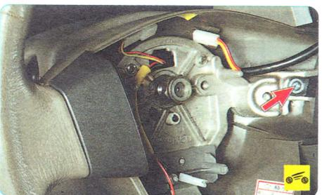
5. ...выверните винт крепления блока...
