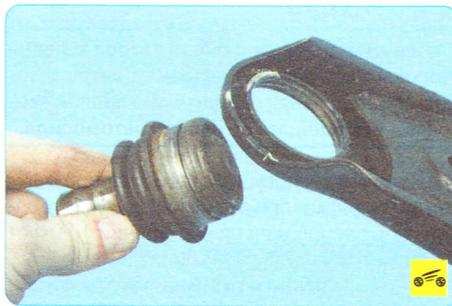
5. ...и снимите шаровую опору с рычага передней подвески.
