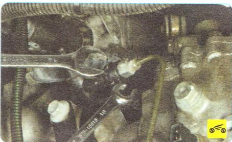
9. Выверните гайки нижней трубки из переходника...
