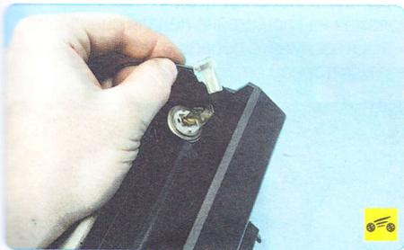
11. Аналогичным образом отсоедините клемму с черным проводом от вывода прикуривателя.
