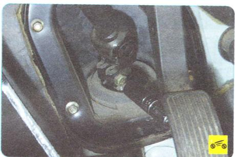
3. Отсоедините от рулевого механизма вал рулевого управления (см. «Снятие и установка рулевой колонки», с. 164).
