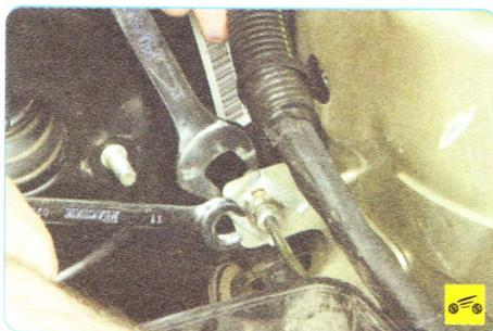
1. Выверните из наконечника шланга трубопровода привода выключения сцепления гайку трубки, удерживая наконечник от проворачивания вторым ключом...
