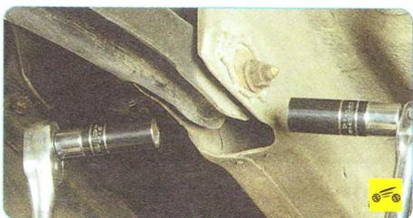
7. Отверните гайку болта крепления рычага к кронштейну на кузове...
