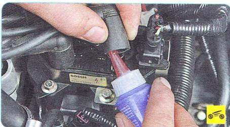
3. Перед установкой обработайте токопроводящей смазкой наконечники высоко-
