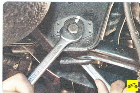
**Угол развала задних колес** характеризуется отклонением средней плоскости вращения заднего колеса от вертикали. Угол развала заднего колеса регулируют вращением регулировочных болтов крепления верхнего поперечного рычага к кронштейну кузова и к задней поперечной балке.
