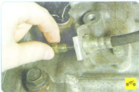
11. Извлеките нижнюю гайку трубки из наконечника шланга.
