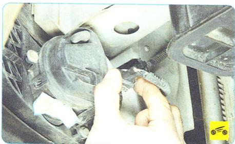
3. Сожмите фиксаторы колодки жгута проводов противотуманной фары...
