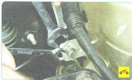
6. Выверните из наконечника шланга трубопровода привода выключения сцепления гайку трубки, удерживая наконечник от проворачивания вторым ключом...
