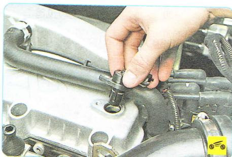
6. ...и снимите датчик фазы с автомобиля.
