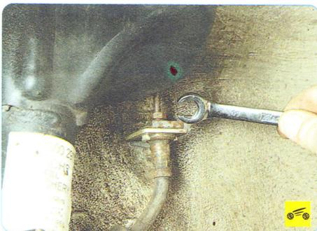
5. Отверните гайку крепления трубки к верхнему наконечнику...
