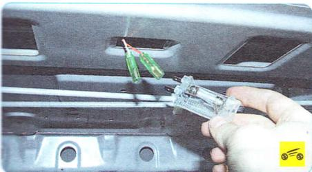
1. Подденьте корпус фонаря, извлеките его из гнезда в кузове...
