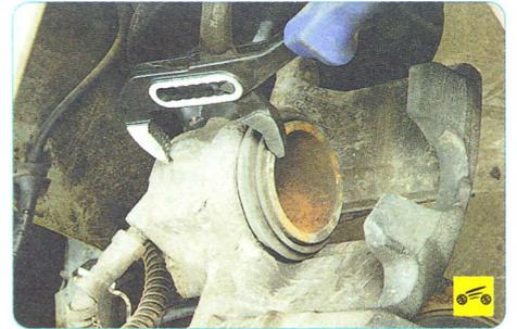
11. С помощью раздвижных пассатижей утопите поршень вглубь рабочего цилиндра до упора.
