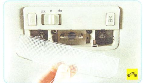
2. ...снимите рассеиватель с плафона...
