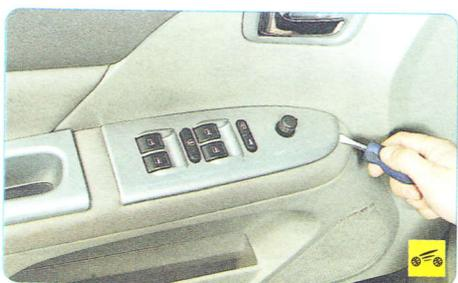
2. Отверткой аккуратно подденьте модуль блоков переключателей стеклоподъемников и регулировки зеркал...
