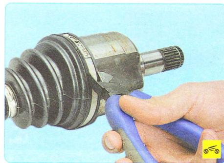
12. Для разборки и замены **внутреннего шарнира** и его чехла снимите хомуты крепления чехла шарнира к его корпусу...
