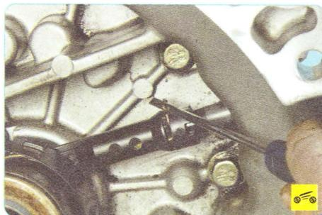
2. Поддев отверткой, приподнимите вверх пружинный фиксатор на хвостовике рабочего цилиндра привода выключения сцепления.
