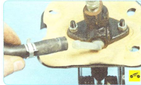
20. ...и отсоедините шланг от главного цилиндра привода выключения сцепления.
