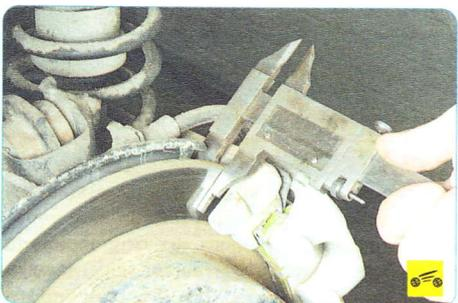
Аналогично проверьте степень износа тормозных колодок и тормозного диска заднего тормозного механизма.
