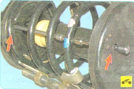
При установке пружины, верхней опорной чашки и верхней опоры отверстие в верхней опорной чашке должно находиться на одной линии с отверстием в нижней опорной чашке.
