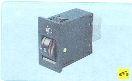
10. ...сожмите фиксаторы блока управления электрокорректором и извлеките выключатель из декоративного щитка.
