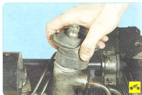
9. Снимите резиновый уплотнительный чехол с картера рулевого механизма.
