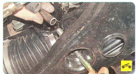
3. Вынимая вниз болт стойки из рычага подвески, снимите оставшиеся распорную и резинометаллическую втулки.
