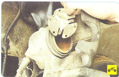
10. ...извлеките из полости поршня рабочего цилиндра прижимную пружину внутренней колодки и осмотрите ее. Деформированную или сильно корродированную пружину замените.
