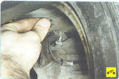
3. Очистите от грязи клапаны выпуска воздуха и снимите защитные колпачки клапанов рабочих цилиндров тормозных механизмов передних...
