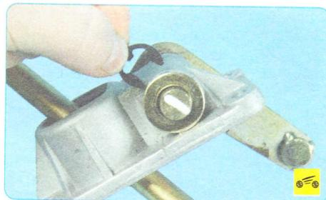
10. ...снимите стопорное кольцо оси рычага выбора передач...
