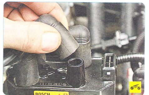
4. Снимите наконечники высоковольтных проводов с выводов катушки зажигания.
