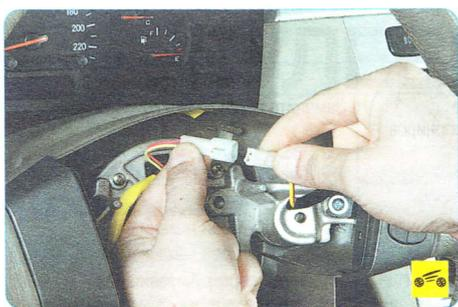
4. Отсоедините колодку жгута проводов блока управления аудиосистемой.
