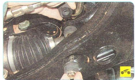
2. Снимите верхнюю резинометаллическую втулку.
