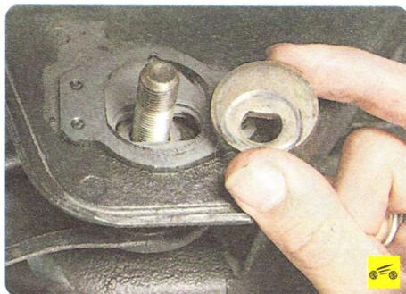
4. ...снимите шайбу и извлеките из кронштейна болт вместе со второй регулировочной шайбой.
