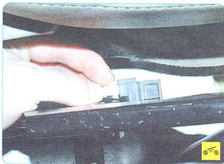
4. ...нажмите на фиксатор колодки жгута проводов выключателя...
