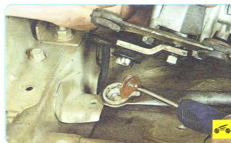
23. Установите моторедуктор стеклоочистителя и все остальные ранее снятые детали в порядке, обратном снятию. При сборке трапеции стеклоочистителя смажьте ее шарниры консистентной смазкой.
