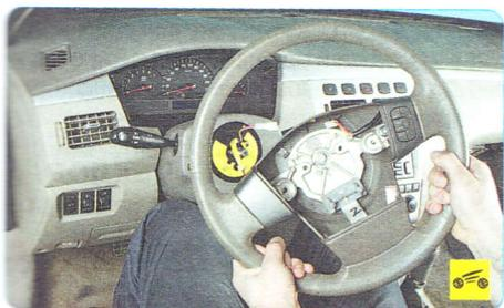
2. Снимите рулевое колесо (см. «Снятие и установка рулевого колеса», с. 163), предварительно установив его в положение, соответствующее прямолинейному движению.
