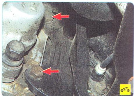
5. Ослабьте затяжку двух болтов крепления направляющей колодок к фланцу рычага задней подвески...
