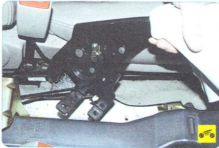
2. Отсоедините рычаг стояночного тормоза от основания кузова (см. «Снятие и установка рычага привода стояночного тормоза», с. 195).
