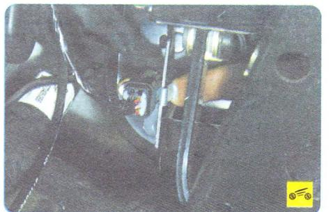
12. Отожмите пружинный держатель и отсоедините от кронштейна педали сцепления жгут проводов.
