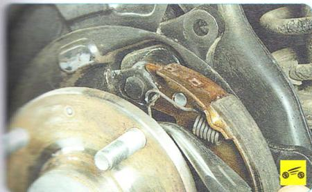
15. Захватив пассатижами с тонкими губками согнутый конец верхней стяжной пружины задней колодки, отсоедините пружину от держателя на щите тормоза...
