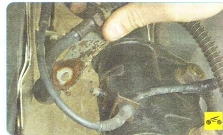
6. ...и снимите кронштейны с корпуса стойки.
