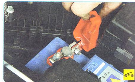
4. Поднимите защитную крышку клеммы «плюс» аккумуляторной батареи...
