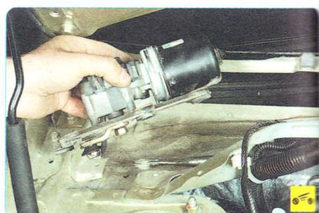
12. Снимите моторедуктор в сборе с пластиной трапеции стеклоочистителя...
