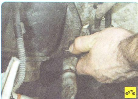
16. Нажмите на пружинный фиксатор колодок жгута проводов датчика положения коленчатого вала...
