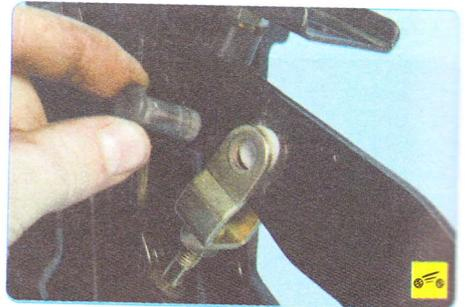
Шток главного цилиндра привода выключения сцепления соединен с педалью вилкой с помощью пальца.
