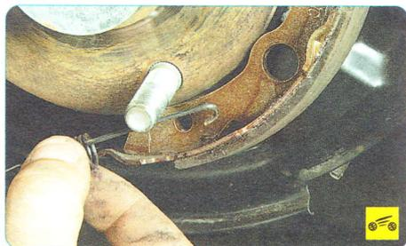
12. ...а также пружину, вынув ее отогнутый конец из отверстия в задней тормозной колодке.
