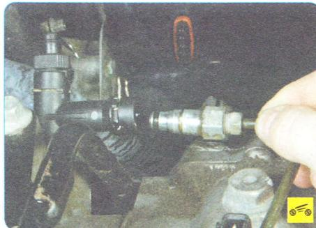
29. ...и нижнюю трубку гидропривода выключения сцепления (см. «Замена трубопровода гидропривода выключения сцепления», с. 133).
