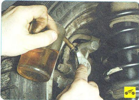
6. Отверните на 1/2–3/4 оборота клапан выпуска воздуха. Из шланга начнет вытекать старая (грязная) тормозная жидкость. Педаль тормоза в это время должна плавно дойти до упора. Как только жидкость перестанет вытекать, заверните клапан выпуска воздуха.
