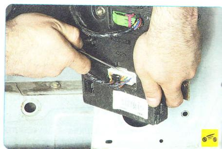
8. Нажмите на фиксатор белой колодки жгута проводов блока...
