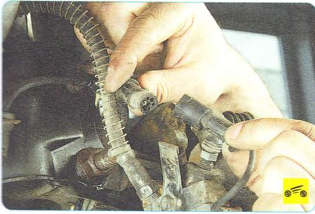
3. ...и разъедините колодку, преодолевая сопротивление ее фиксатора.
