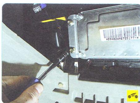
5. Выверните четыре винта крепления блока управления...
