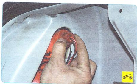
2. Поверните против часовой стрелки патрон лампы габаритного света и стоп-сигнала...
