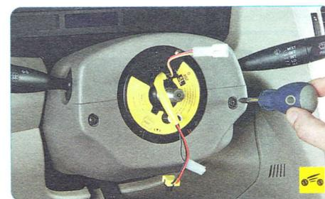
2. Выверните на торцевой поверхности кожуха два винта крепления.
