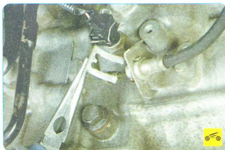
12. Снимите пружинную скобу крепления нижнего наконечника переднего шланга...
