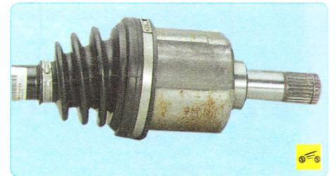
– внутренний шарнир должен перемещаться в угловых и осевых направлениях с легким усилием, при этом не должно ощущаться рывков, заеданий и радиальных люфтов. В противном случае замените внутренний шарнир;
