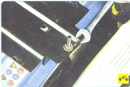
11. Ослабьте затяжку гаек стяжек крепления аккумуляторной батареи...
