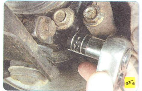
4. Отверните гайку стяжного болта...
