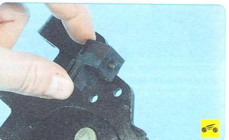
13. ...и снимите выключатель.
