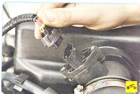
2. Сожмите пружинный фиксатор и отсоедините от датчика колодку жгута проводов.
