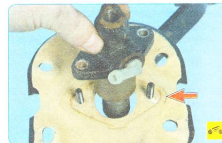
При замене педали снимите с нее главный цилиндр привода выключения сцепления (см. «Замена главного цилиндра привода выключения сцепления», с. 130)...
