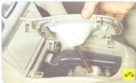
3. ...извлеките рамку из гнезда и поднимите чехол вверх по рычагу.
