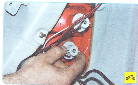
2. Поверните против часовой стрелки патрон лампы света заднего хода...
