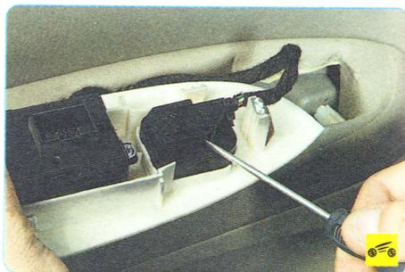
6. Нажмите на фиксатор колодки жгута проводов блока управления зеркалами...
