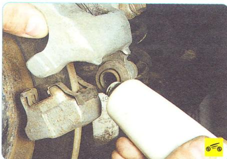
...а затем смажьте смазкой защитный чехол пальца.
