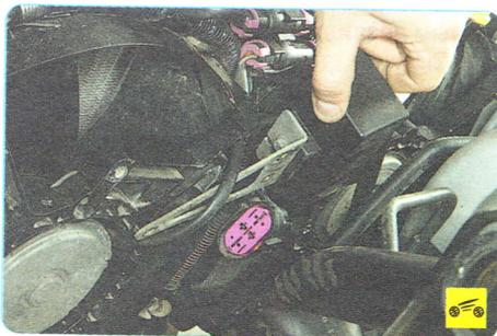
5. ...и снимите дополнительное сопротивление в сборе с кронштейном.
