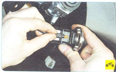
4. Поверните лампу подсветки против часовой стрелки...
