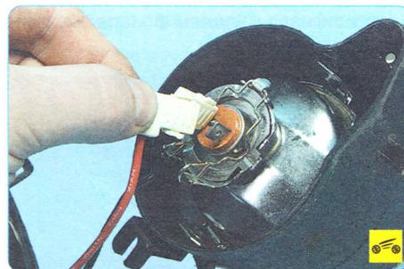
4. Отсоедините колодку жгута проводов от выводов лампы...
