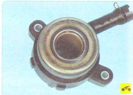
Перед установкой проверьте новый подшипник. Он должен вращаться легко, без заеданий и шума и не иметь люфтов. Проверьте легкость перемещения подшипника на направляющей рабочего цилиндра, нажав на него в осевом направлении. Подшипник должен перемещаться до упора без заедания и четко возвращаться в исходное положение поджимной пружиной.
