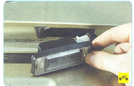
3. ...и извлеките его из отверстия в крышке багажника.
