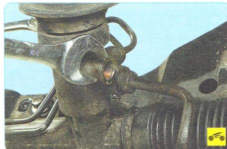
18. Отверните гайку крепления трубопровода нагнетательной магистрали...
