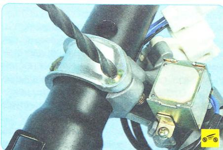
3. Высверлите два срывных болта крепления замка зажигания к рулевой колонке и снимите выключатель (замок) зажигания с рулевой колонки.
