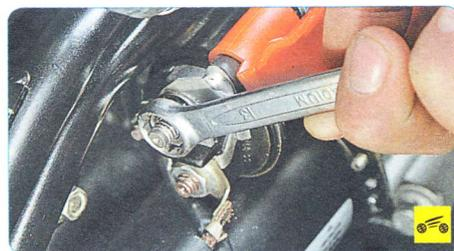
4. Отверните гайку крепления силового провода и снимите провод с контактного болта тягового реле.
