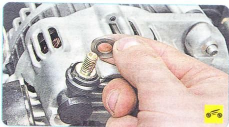
4. Снимите с вывода генератора шайбу, установленную под наконечником силового провода.
