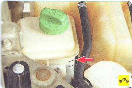
1. Залейте рабочую жидкость в систему гидроусилителя до максимального уровня (см. «Проверка уровня и доливка рабочей жидкости в бачок гидроусилителя рулевого управления», с. 60).
