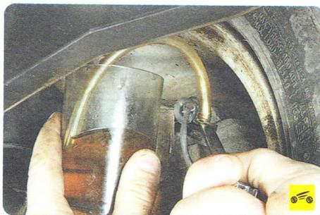
7. Таким же способом замените тормозную жидкость в рабочем цилиндре тормозного механизма левого переднего колеса.
