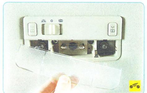
3. ...и снимите рассеиватель с плафона...
