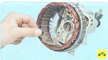
13. ...снимите пластмассовый кронштейн крепления...
