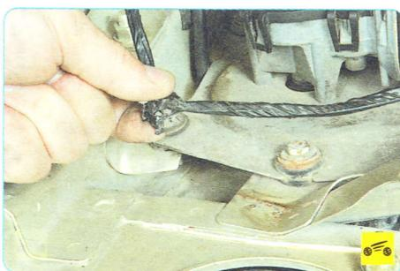
5. Снимите фиксатор жгута проводов с пластины трапеции стеклоочистителя.
