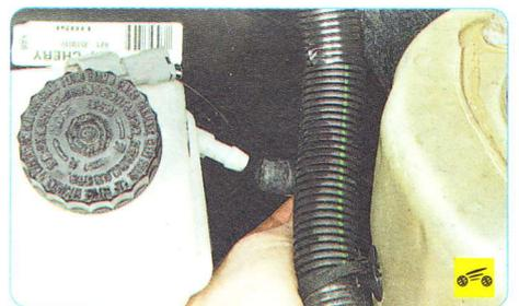
2. Отсоедините от бачка главного тормозного цилиндра шланг к главному цилиндру
