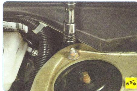
12. Отверните три гайки крепления верхней опоры к кузову...
