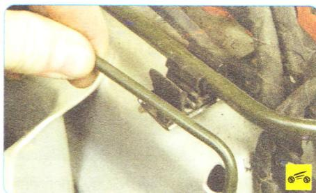
7. Извлеките трубку из держателя на брызговике моторного отсека...
