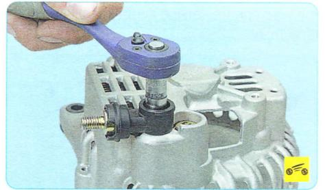
17. ...отверните гайку контактного болта...
