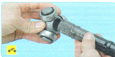
20. Снимите со шлицев вала ступицу с роликами, после чего снимите с вала защитный чехол.
