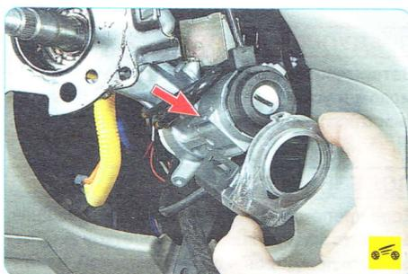
6. Сдвиньте кольцо подсветки замка зажигания по салазкам на его корпусе и снимите с замка.
