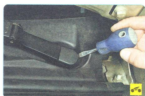
2. Снимите заглушку гайки крепления рычага...
