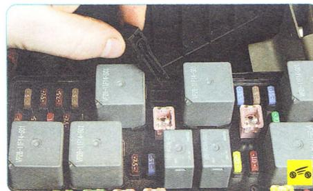
3. Для удобства замены предохранителей воспользуйтесь пинцетом, расположенным в одном из гнезд монтажного блока...
