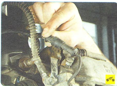
5. Извлеките из держателя колодку жгута проводов датчика износа накладки внутренней тормозной колодки...
