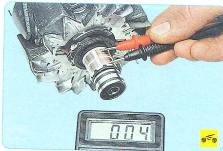
26. Проверьте тестером сопротивление обмотки ротора, подсоединив его к контактным кольцам. Сопротивление должно составлять порядка 3–5 Ом. Если тестер покажет бесконечность, значит, в обмотках обрыв и нужно заменить ротор.
