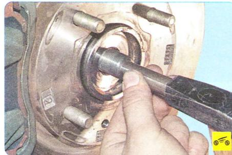
При затрудненном выведении хвостовика наружного шарнира аккуратно, не повреждая резьбы, выбейте его из ступицы оправкой подходящего размера.
