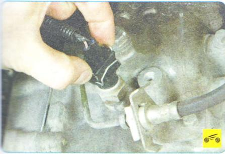
24. Сожмите пружинный фиксатор колодки жгута проводов выключателя света заднего хода...
